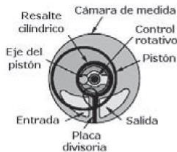
Figura N° 14: “Esquema de un medidor de flujo tipo Pistón Oscilante”
