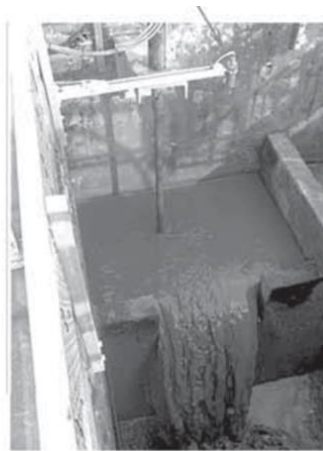
Figura N° 8: “Fotografía de un sistema de medición de flujo basado en un Vertedero”
