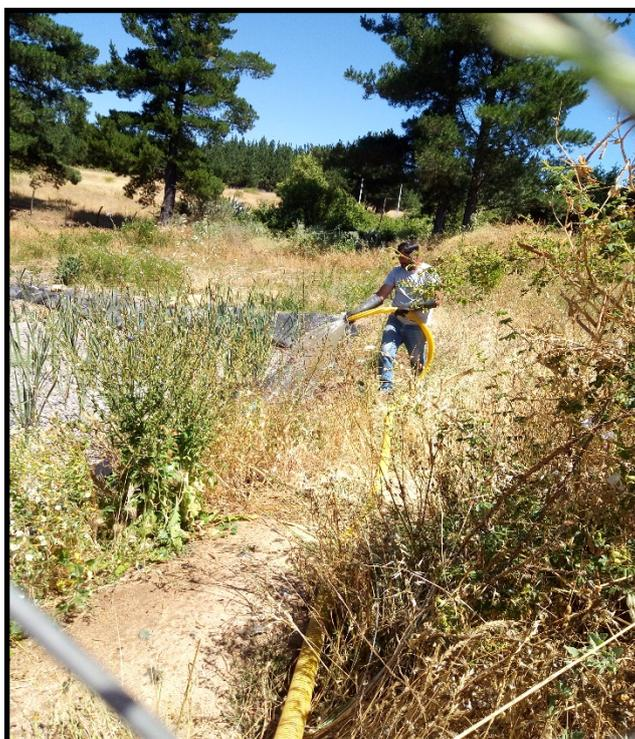
**Figura 33. Simulación de lluvia artificial sobre el talud. (Fuente propia)**
