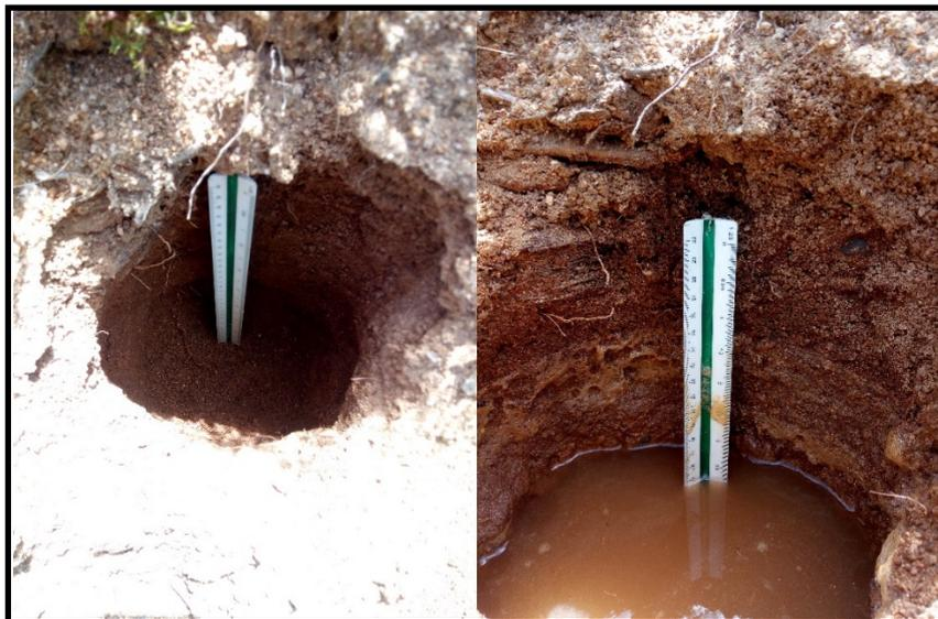
**Figura 27. Ensayo Potcher N°1 suelo SM. (Fuente propia)**
