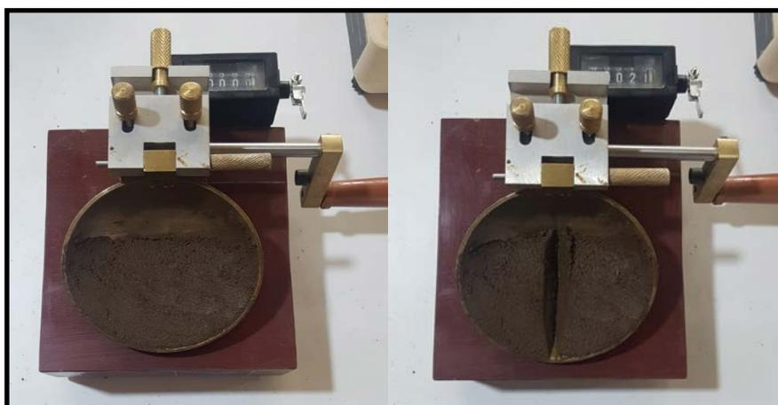
**Figura 22. Determinación de límite líquido utilizando maquina Casa Grande. (Fuente propia)**
