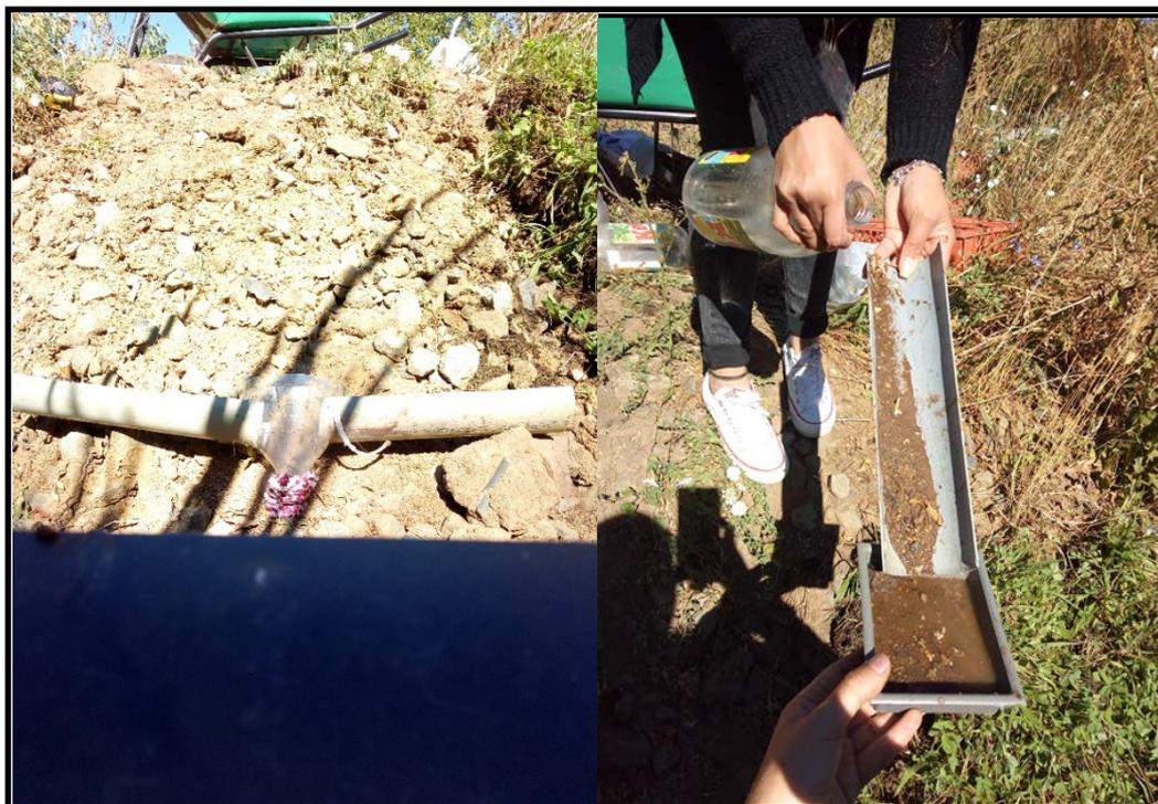
**Figura 38. Determinación arrastre de material sin capa vegetal. (Fuente propia)**
