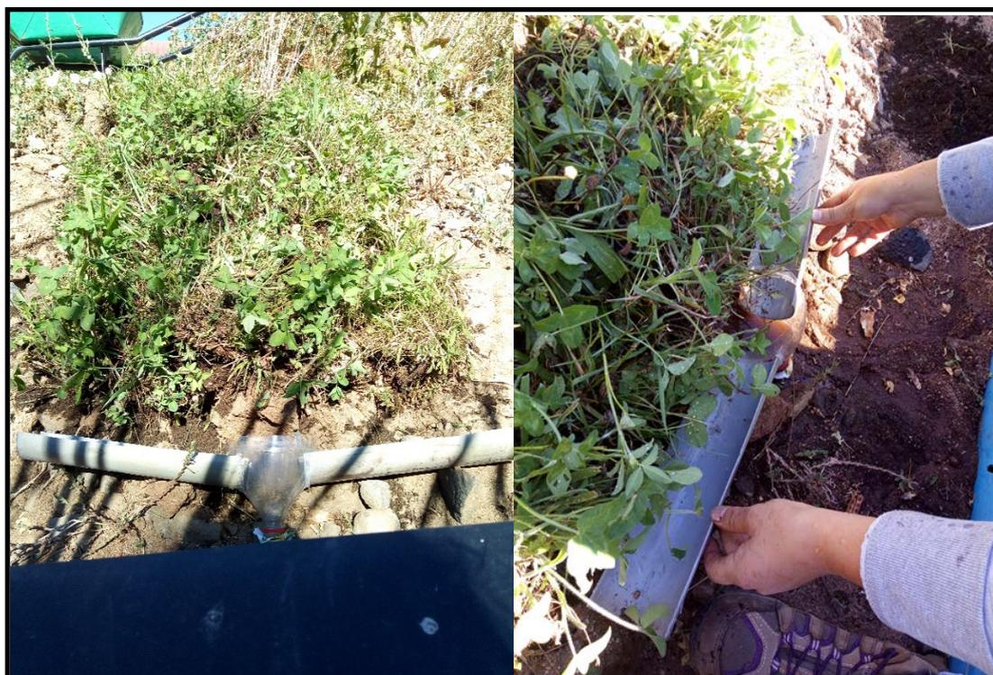
**Figura 39. Determinación arrastre de material implementando vegetación. (Fuente propia)**
