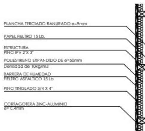
Figura 6. Corte Escantillón, Muro.
