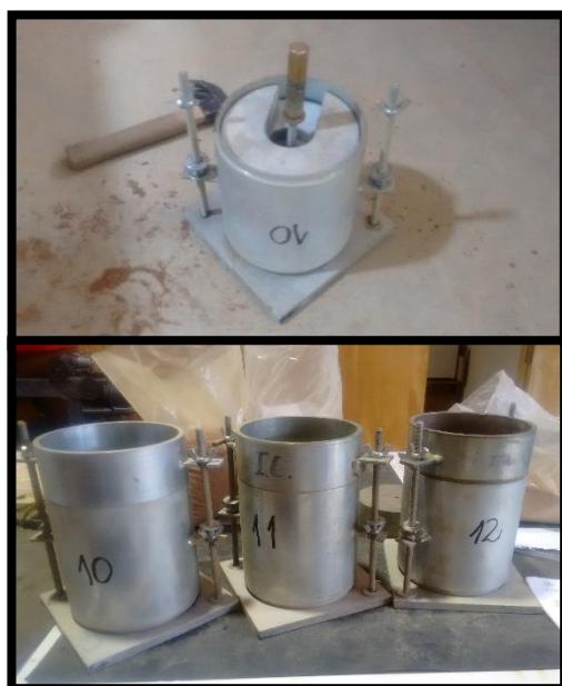
Figura B9: Moldes utilizados para realización de ensayo CBR
