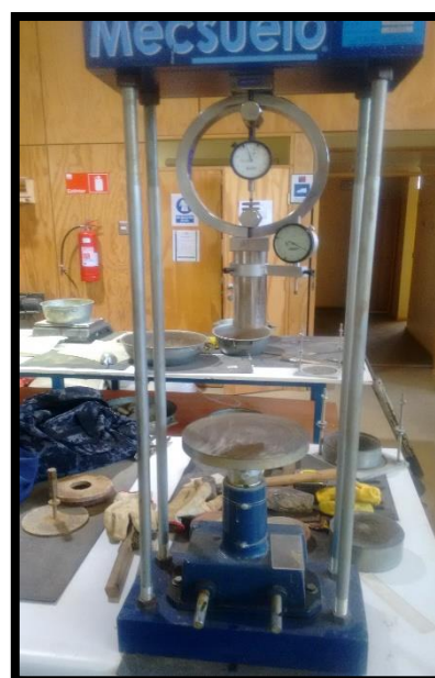
Figura B10: Banco de trabajo para realizar ensayo CBR.
