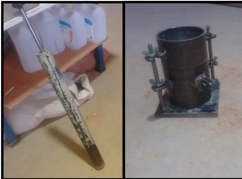
Figura B8: Martillo compactador y moldes utilizados para realizar ensayo Proctor modificado
