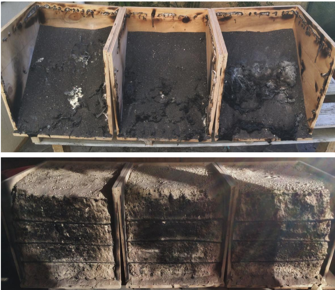
Figura N°13. Deterioro de taludes finalizado el ensayo.
