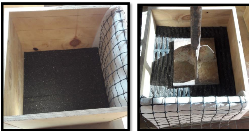
Figura N°10. Llenado módulos de arena gruesa.
