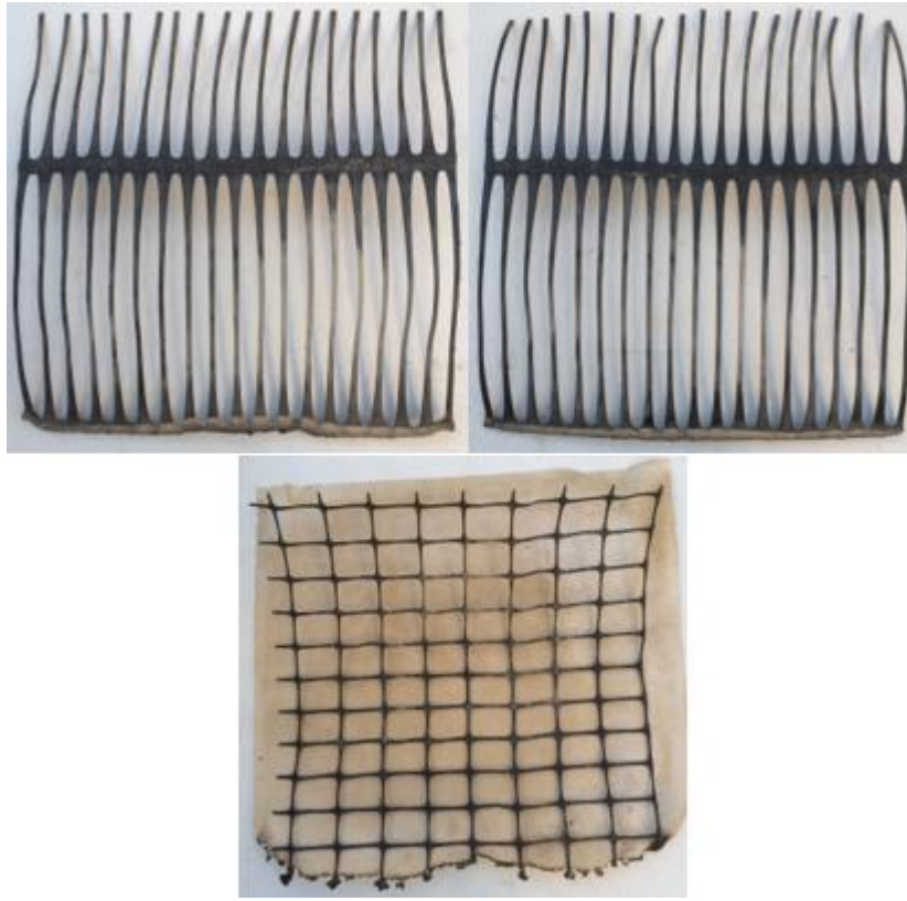
Figura N°17. Deterioro estructura de retención taludes de arena limosa.
