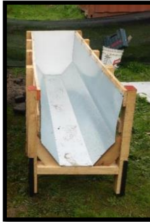
Figura A4: Canales con superficie reflectante.
