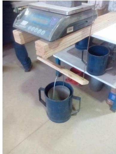
Ensayo de masa sumergida.
