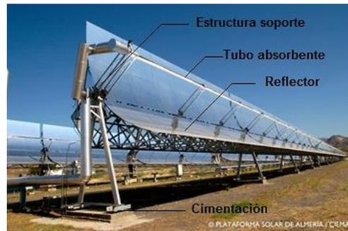
Figura 1.17: Componentes de un CCP [7]
