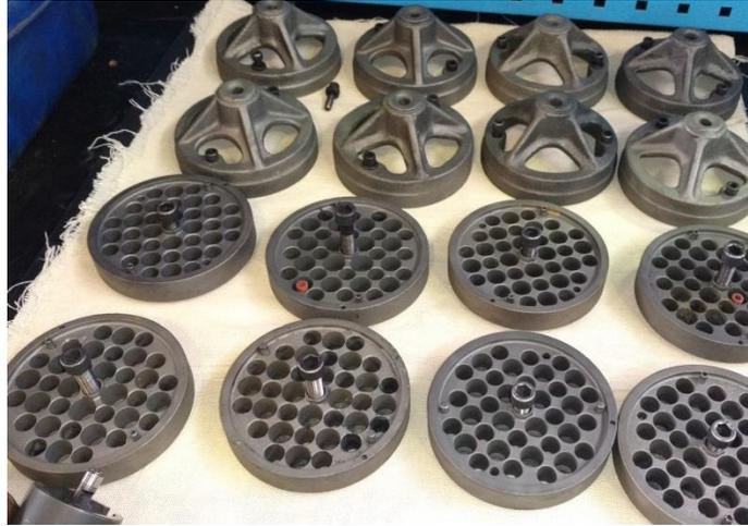
FIGURA 4-26. Válvulas de succión y descarga limpias. (Fuente: ENAP Refinerías Bío Bío).
