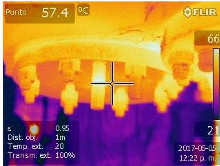
FIGURA 4-10. Análisis de termografía de una Válvula de descarga de un compresor recíprocante. (Fuente: ENAP refinерías Bío Bío).
