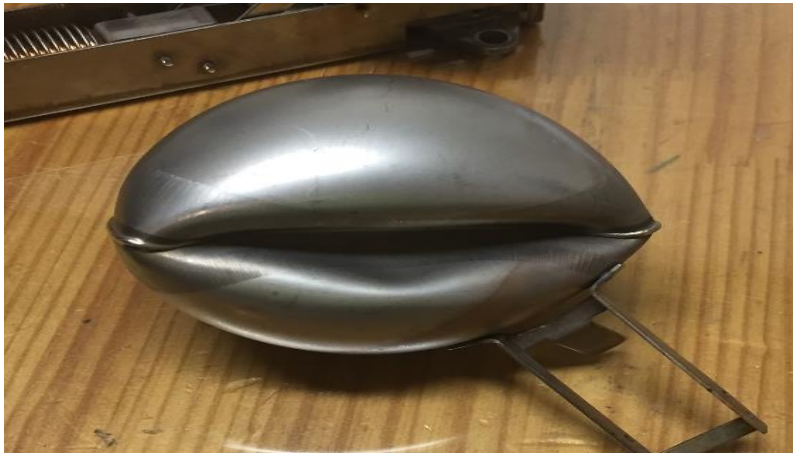
Figura 5.3: Flotador de trampa afectado por golpe de ariete. (Fuente: Elaboración propia)
