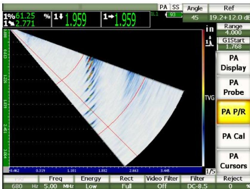
Figura: 8.9: Imagen en representación Phased array.
