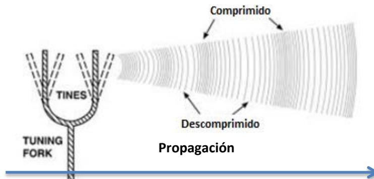
Figura 2.3: Ondas longitudinales.
