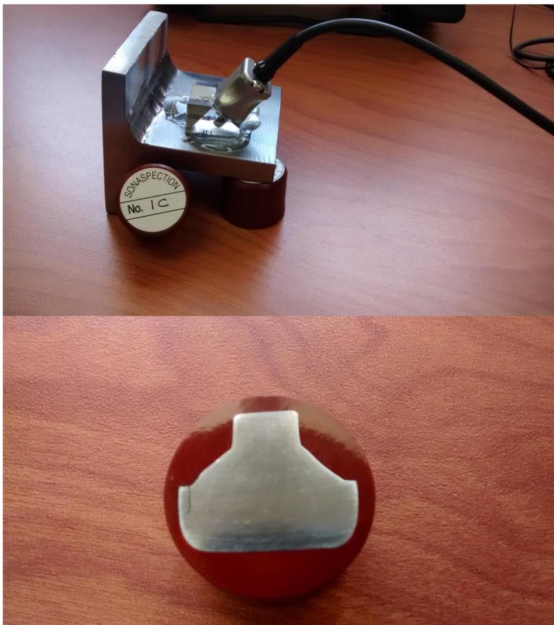
Figura 9.5: Probeta N°1c (arriba) y muestra del defecto de ésta (abajo).
