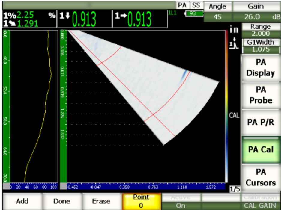
Figura 8.7: Calibración ganancia de referencia.
