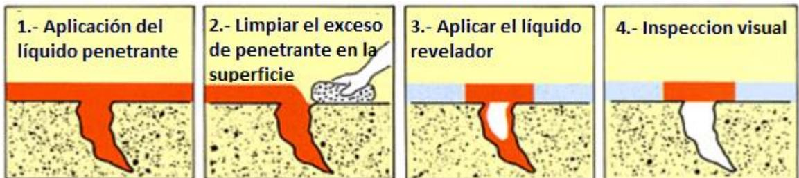
Figura 1.1: Procedimiento aplicación líquidos penetrantes.
