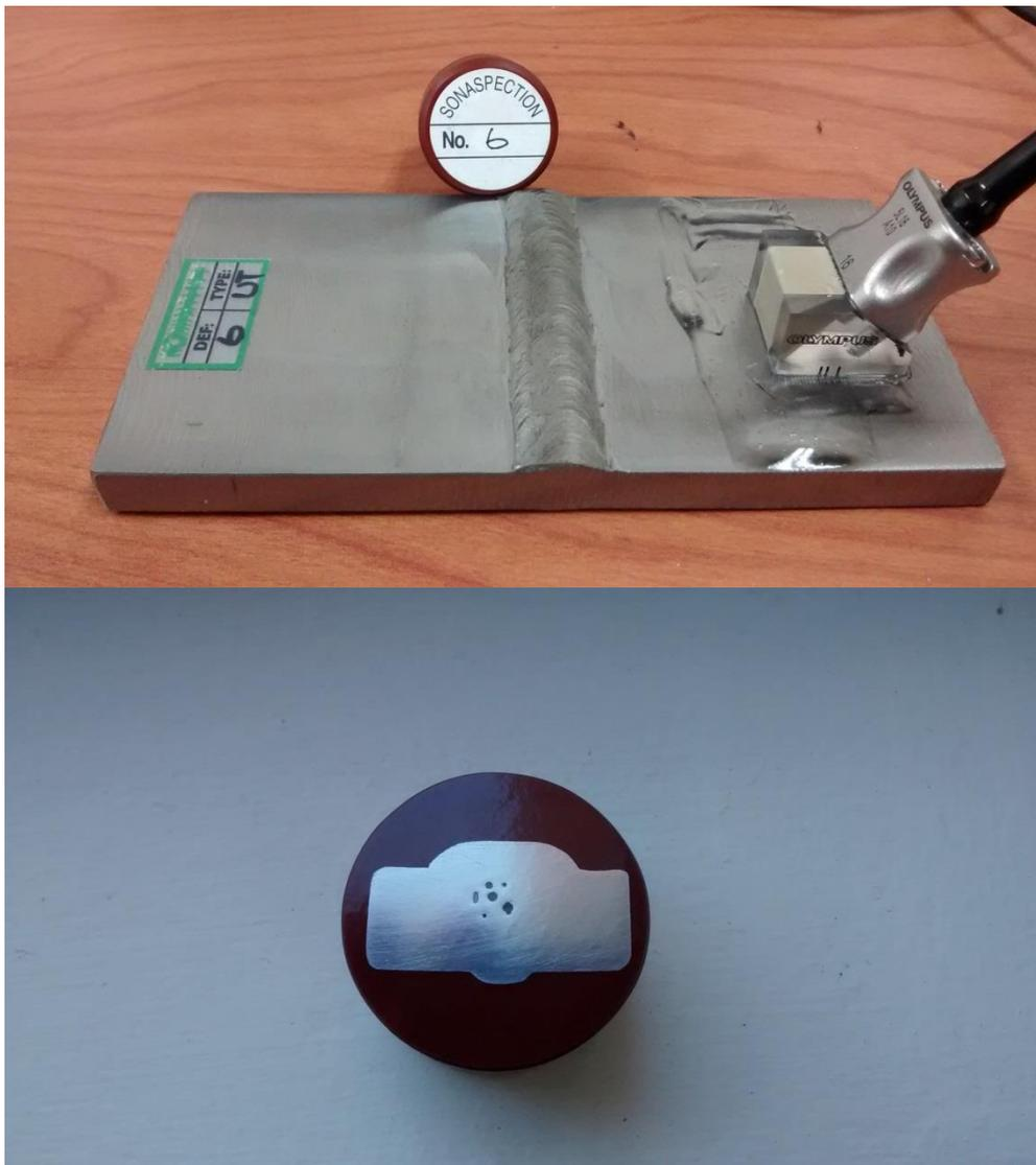
Figura 9.1: Probeta N°6 (arriba) y muestra del defecto de esta (abajo).
