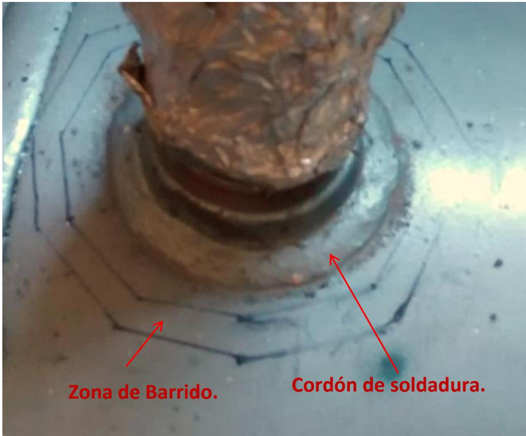
Figura 10.3: Zona de barrido y cordón a inspeccionar en junta circular.
