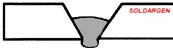
Figura 6.8: Penetración excesiva en soldaduras.
