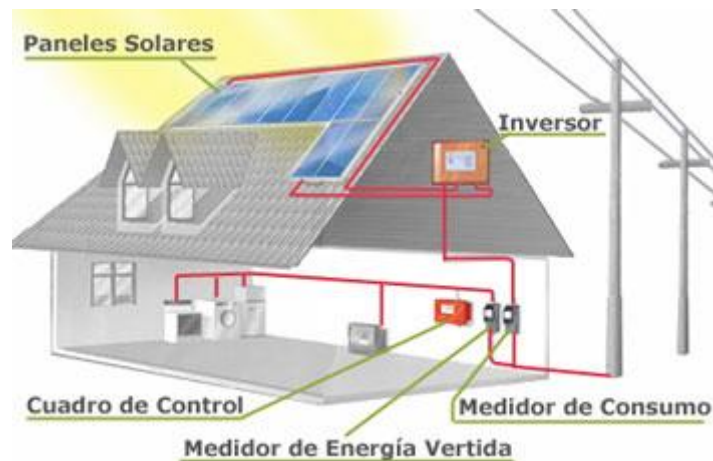
Figura 4.12. Instalación conectada a la red eléctrica (Estudio Solar)
