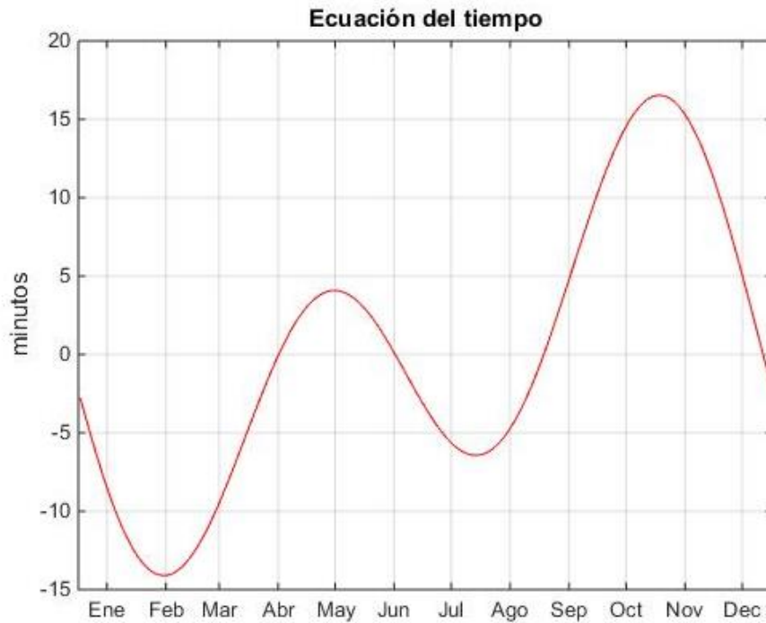
Figura 3.3. Ecuación del tiempo respecto a los meses del año
