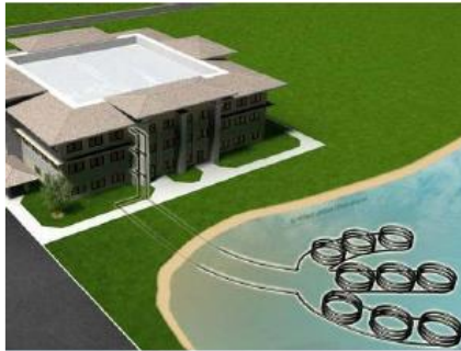
Figura 3.8: Instalación de cañería en espiral sumergida en laguna.
