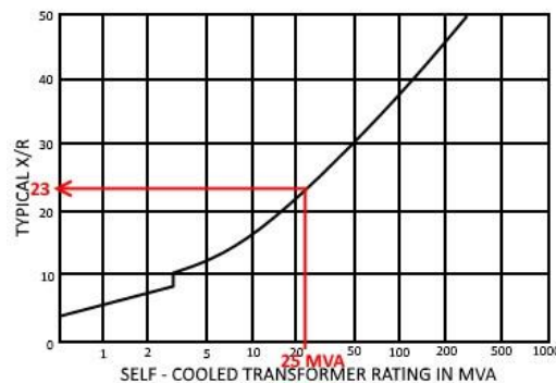
Figura 3.18: relación X/R en transformador
