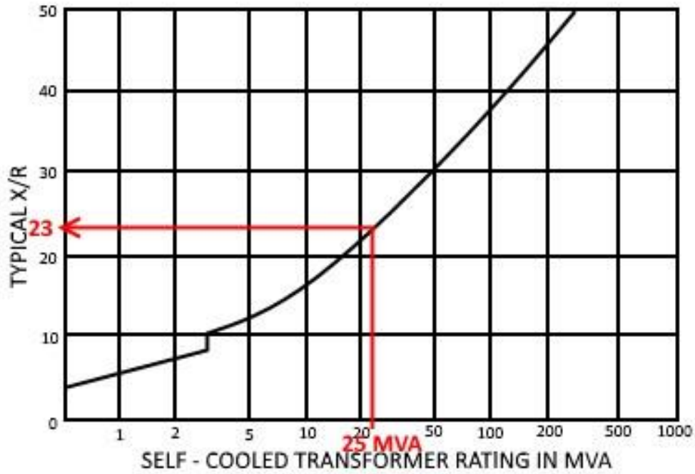
Figura 3.17: relación X/R en transformador
