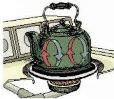
Figura N° 2.3: En una tetera el agua en contacto con el metal caliente asciende y desplaza el agua fría.
