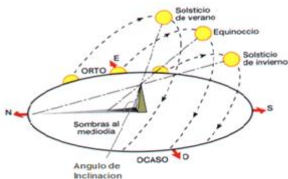
Figura N° 6.5: Inclinación de un panel solar.
