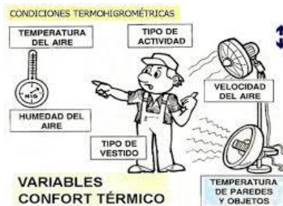
Figura N° 1.1: Variables de un confort térmico.
