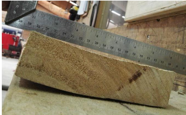
Figura 4.8 Pieza con defecto de acanaladura. Fuente Elaboración propia.
