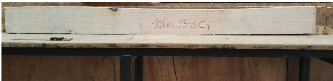
Figura 4.7 Pieza con defecto de encorvadura. Fuente Elaboración propia.
