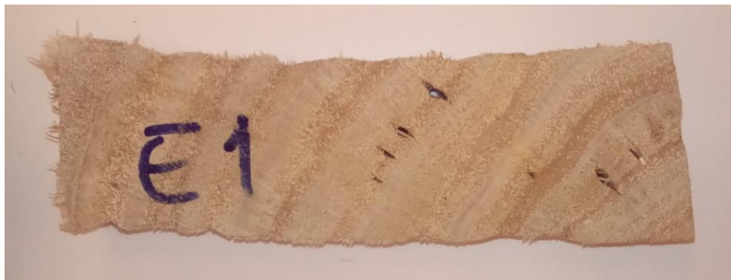
Figura 3.11 Piezas de Eucalyptus nintens con presencia de grietas internas. Fuente Elaboración propia.
