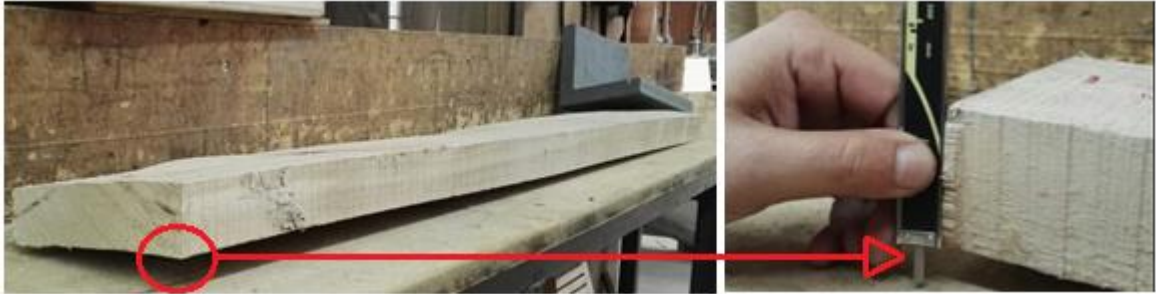
Figura 4.5 Medición de la torcedura. Fuente Elaboración propia.
