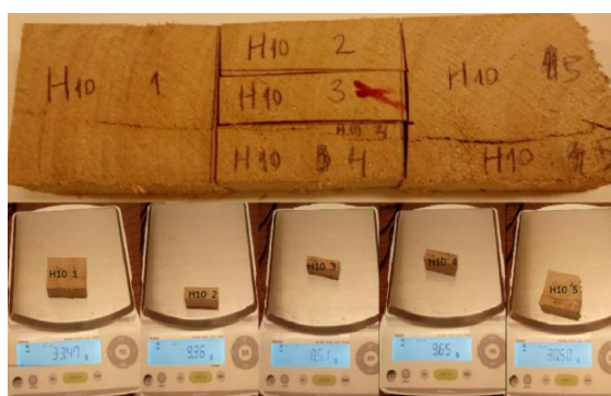
Figura 4.11 Cortes realizados para la determinación del gradiente de humedad de las piezas.
