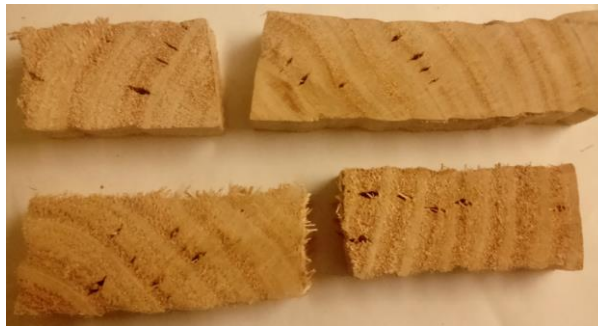
Figura 4.9 Piezas de Eucalyptus nitens con presencia de grietas internas. Fuente Elaboración propia.
