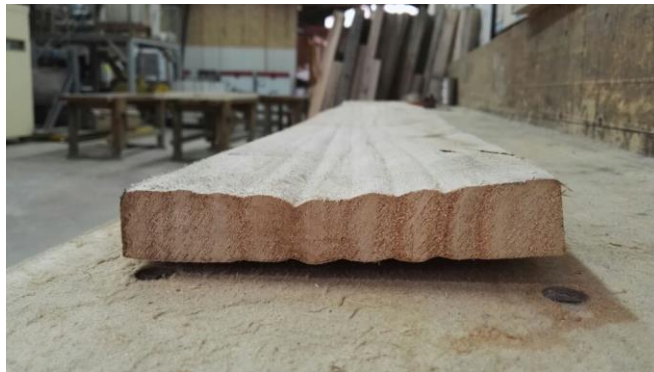
Figura 3.3 Pieza aserrada de Eucalyptus nitens con presencia de Colapso.
