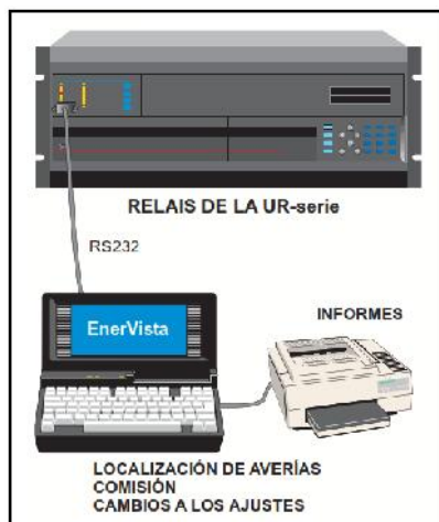
Figura 3.21: Comunicación del relé, vía puerto RS232
