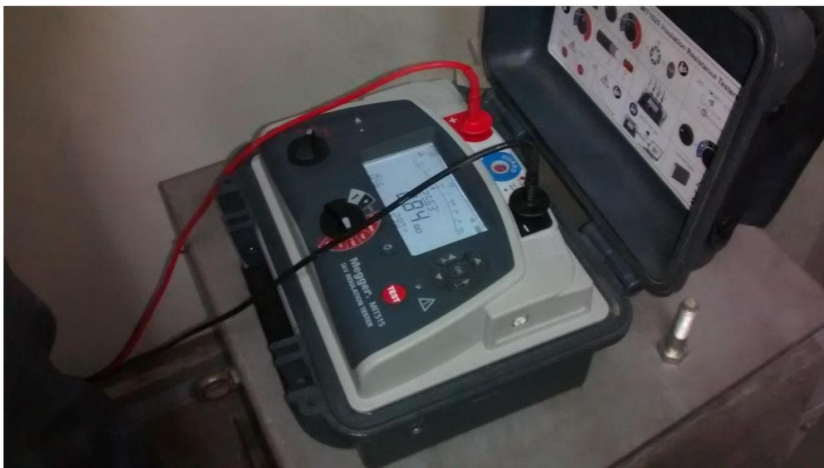
**Figura 1.20: Equipo Megger utilizado en la Prueba de Aislación**
