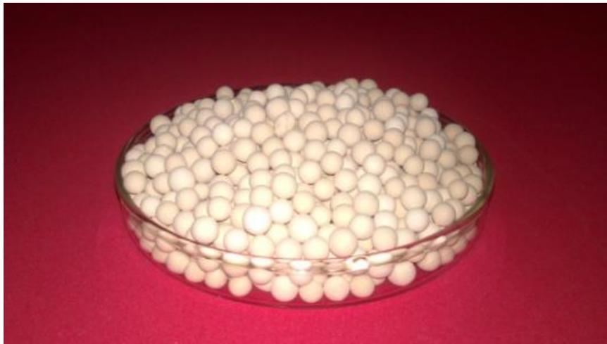
**Figura 1.11: Zeolitas esféricas usadas para el proceso de oxigenación**
