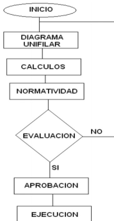
**Figura 1.3: Flujograma de las actividades del diseño del CCM**
