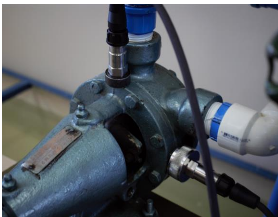
Figura N°13 Ubicación de los acelerómetros en forma horizontal y vertical.
