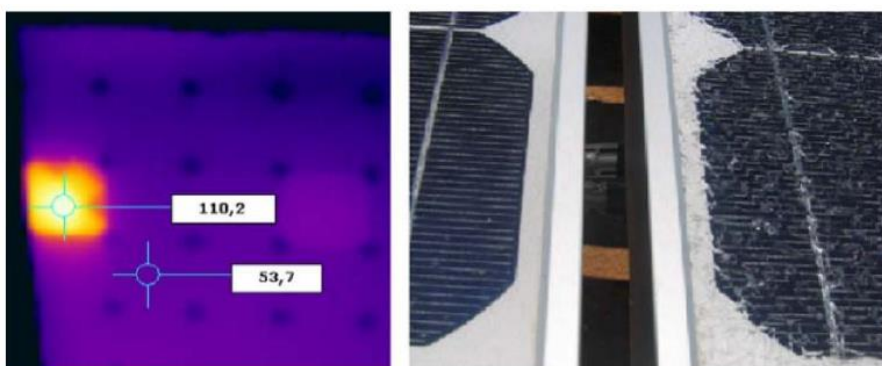
Figura 5.41 Daño por temperatura a celdas fotovoltaicas.
