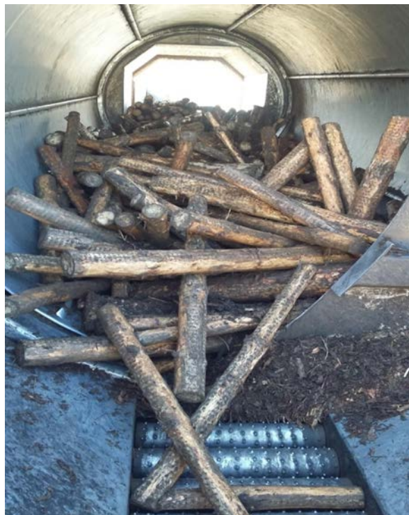
Figura 1.4: Vista interior del descortezador
