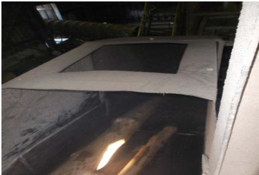
Figura 1.5: Vista de trozo ingresando al Chipeador
