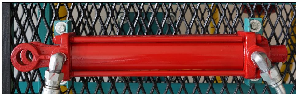
Fig. 3.8 Cilindro hidráulico de doble efecto.
