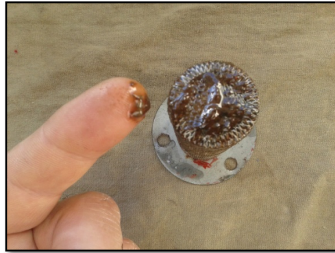
Fig. 1.6 Tapa de llenado y su filtro de malla metálica.
