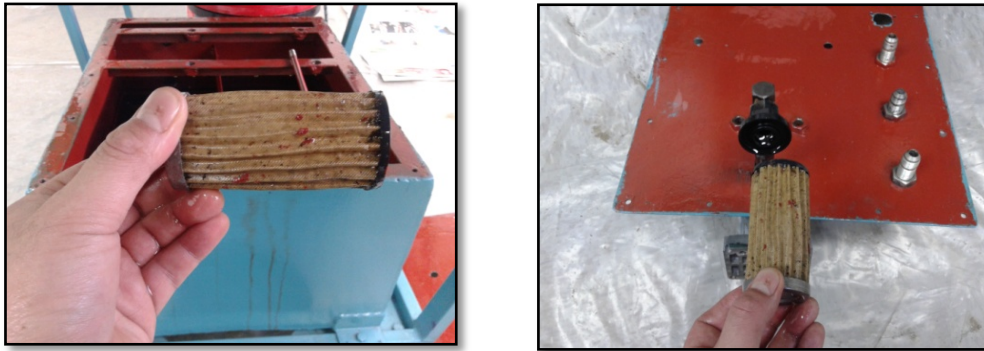
Fig. 1.5 Filtro de succión de malla metálica.
