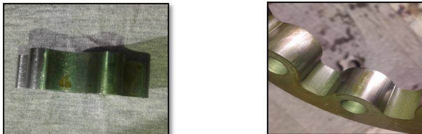
Fig. 1.10 Óxido en rotor de lóbulo y su anillo exterior.
