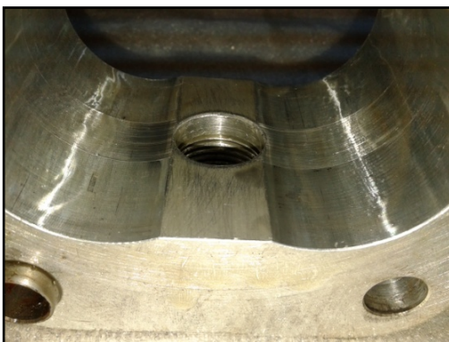
Fig. 1.8 Desgaste en cuerpo de bomba de engranajes.
