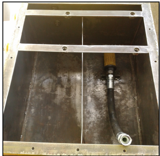
Fig. 1.7 Tanque hidráulico con filtro de succión y soporte.
