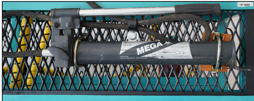
Fig. 3.3 Bomba hidráulica manual o porta power.
