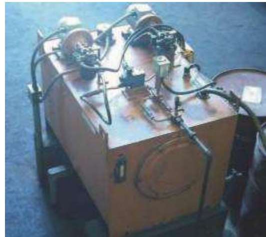
Imagen N° 31 y 32: Central de lubricación por niebla
