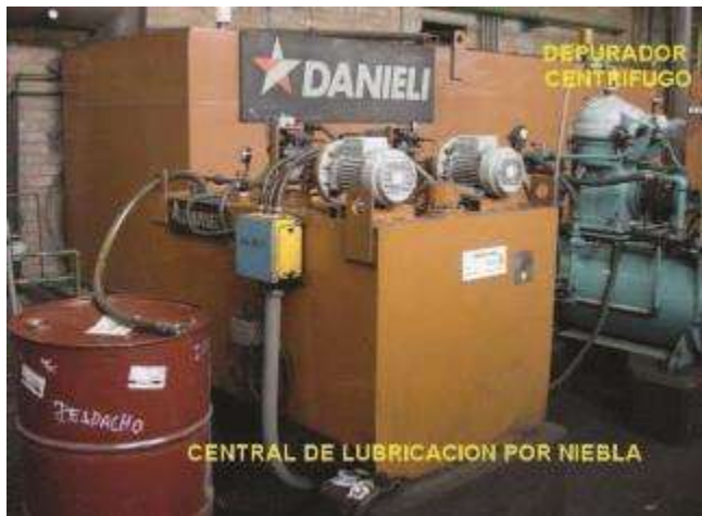
Imagen N° 31 y 32: Central de lubricación por niebla
