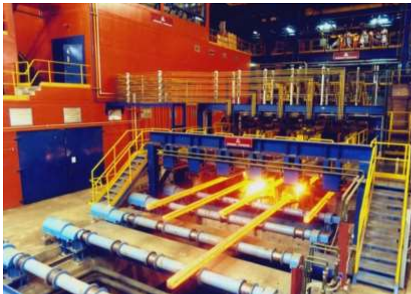
Imagen N° 13: Barra saliendo al rojo en el área de colada continua
