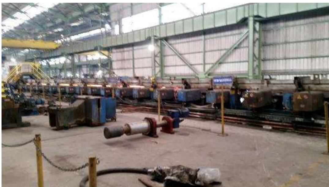
Imagen N° 14: Laminador de Barras en proceso continuo.
