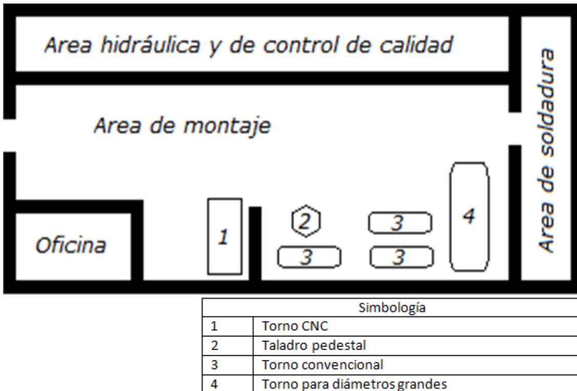
Figura 25. Esquema de distribución del área del taller
