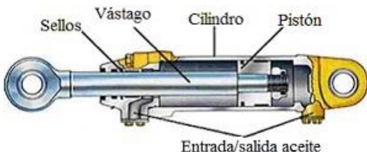
Figura 1. Corte de un cilindro hidráulico.
