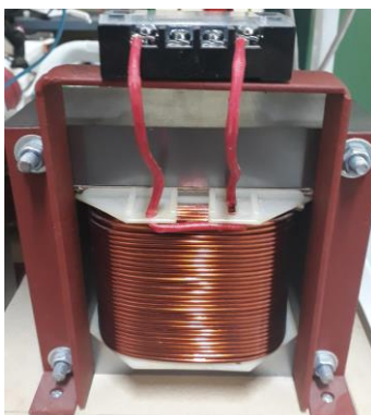
Figura 3.3 Inductor para filtro LDC.
