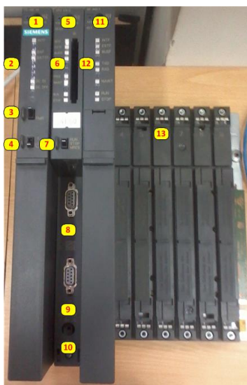
Figura N°7: “Estación de automatización SIMATIC S7-400”.
