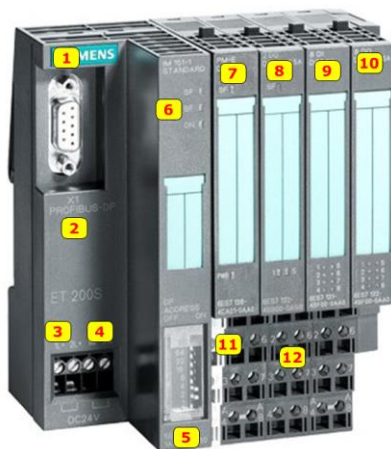
Figura N°29: “Estructura de la estación ET 200S”.
