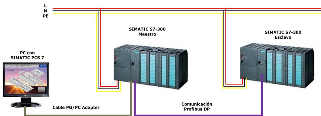
Figura N°51: “Esquema de red Profibus con puerto DP integrado”.
