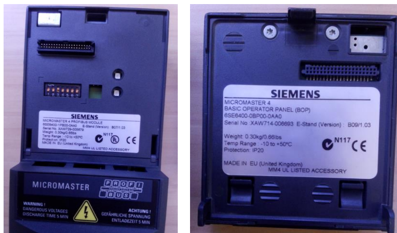
Figura N°134: Interruptores DIP para la asignación de dirección de Profibus.
