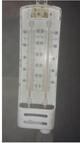
Figura N°3: “Termómetros que miden la temperatura de bulbo seco y húmedo”
