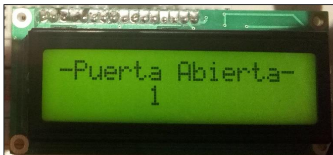
Fig. 8.13: Mensaje arrojado cuando se vuelve a abrir la gaveta, esta vez con la nueva cantidad detectada.
