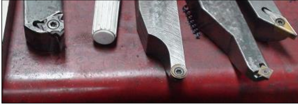
Fig. 2.2: Herramientas de corte. Se pueden apreciar tanto los insertos como sus respectivos porta-insertos o vástagos.
