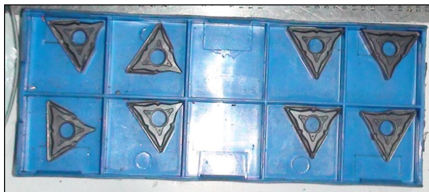
Fig. 3.2: Caja contenedora de 28x28 [mm], con insertos en su interior.
