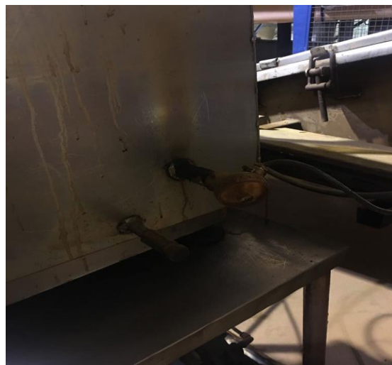
Figura 10. Estanque de etoxiquina con una PT100.
