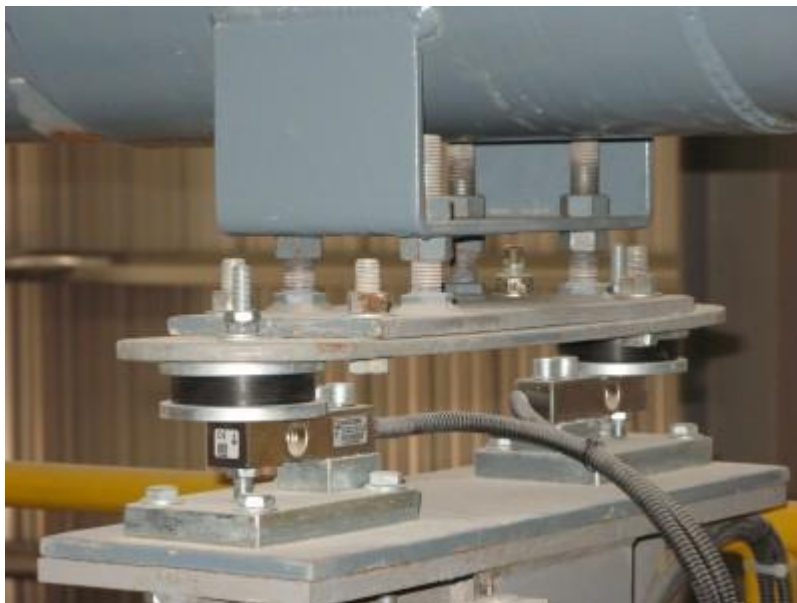
Figura 39. Ejemplo de uso de celdas de carga en un transportador de tornillo
