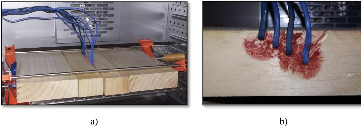
Figura 1.3. Ensayo de perfiles de temperatura: a) montaje al interior de la cámara, b) detalle de la instalación de termocuplas.
