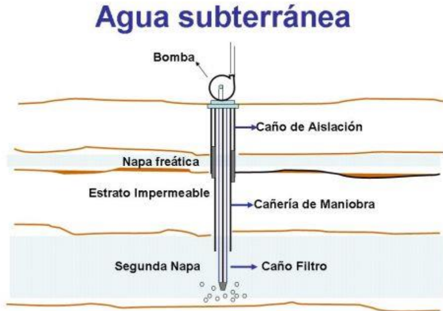
Fig. 1.1. Esquema de captación de agua subterránea.
