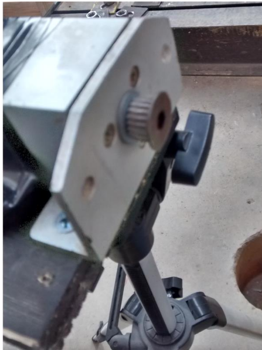
Figura 2.2 Transductor de desplazamiento montado en trípode
