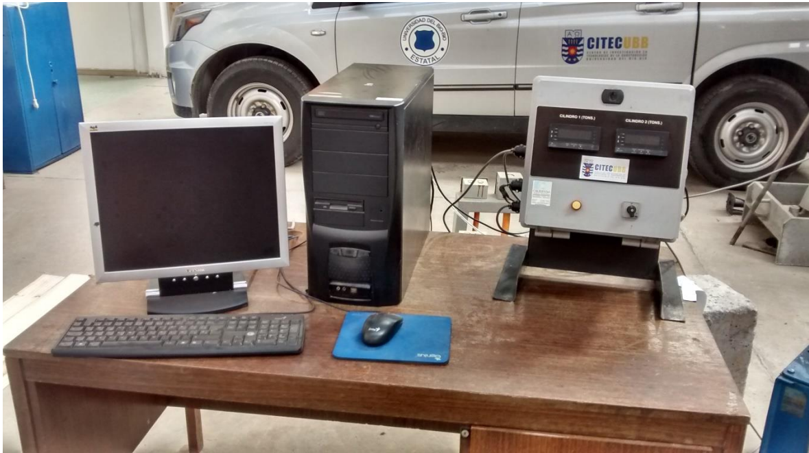
Figura N°2.6 Modulo de adquisición de Datos de proceso
