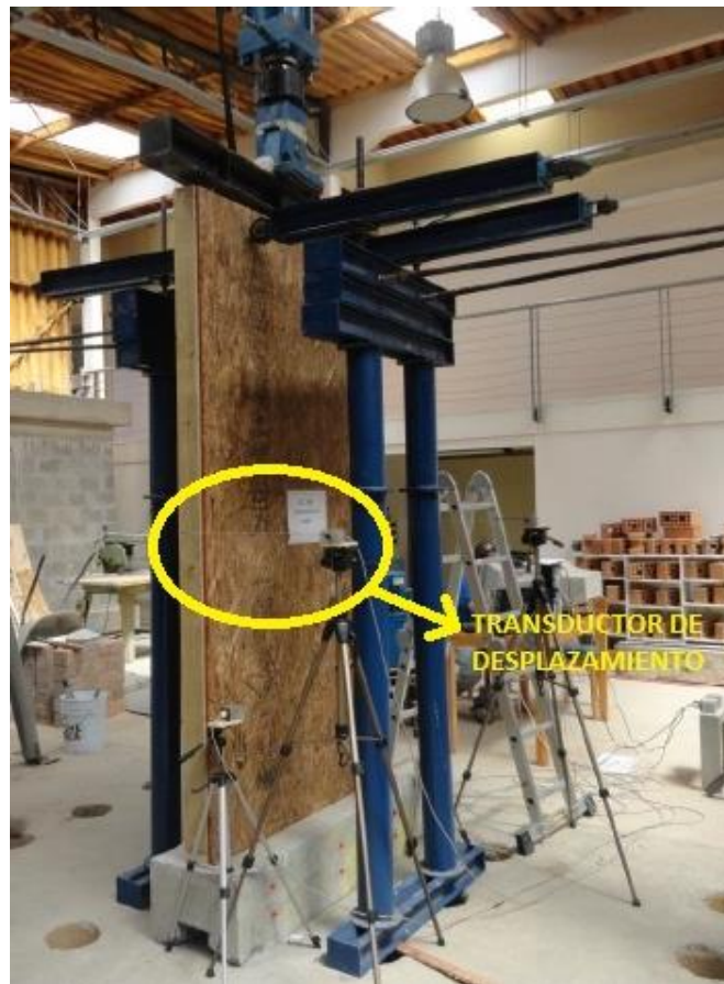
Figura N°1.5 Ubicación transductores de desplazamiento
