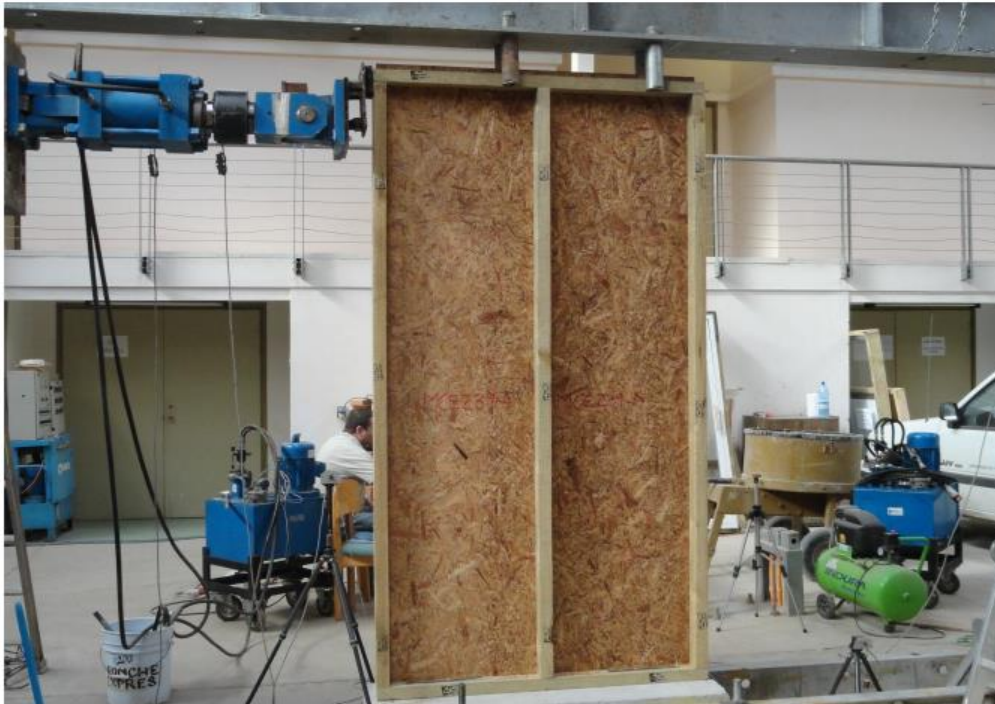
Figura N°1.4 Implementación ensayo de carga horizontal
