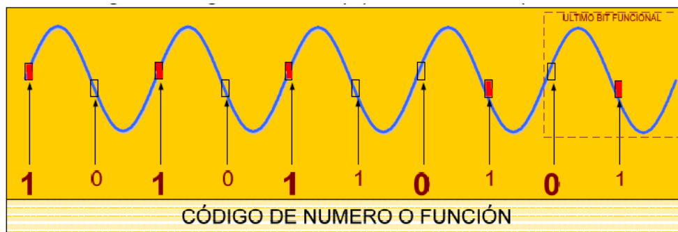
Figura 1.10 Diagrama de envío del código de función 2=11100
