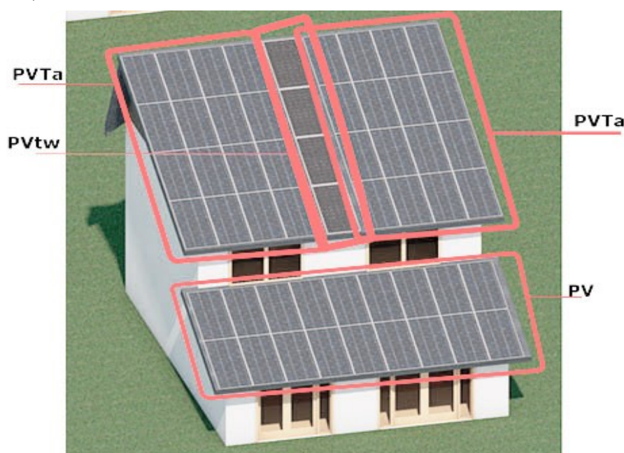
Figura 6.9: Instalación de tecnologías híbridas conjuntas BIPVTa más BIPVTw complementado con BIPV en Modelo C (El Autor)
