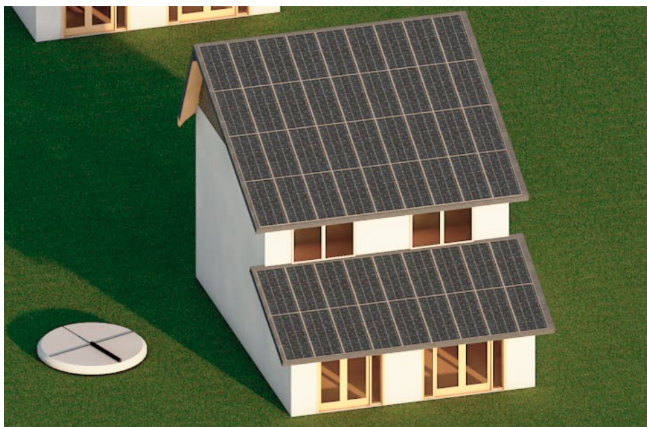
Figura 6.3: Despliegue de colectores BIPV en faldones de modelo propuesto (El autor).
