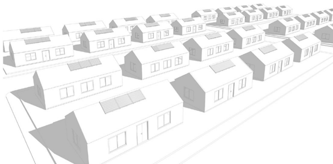
Figura 13: Conjunto de viviendas con sistema de colectores dimensionados e integrados en Archicad y Ecodesigner. (Los Autores)
