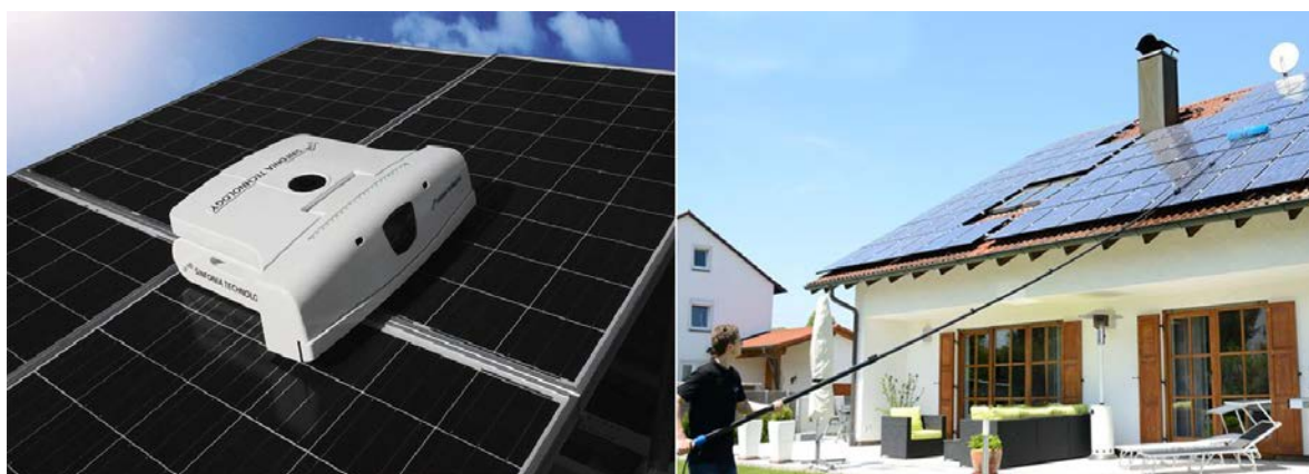
Figura 2.9: Sistemas y servicios de Limpieza PV robóticos y manuales (Nikkei Business Publications 2015; Nanocleansolar 2015).
