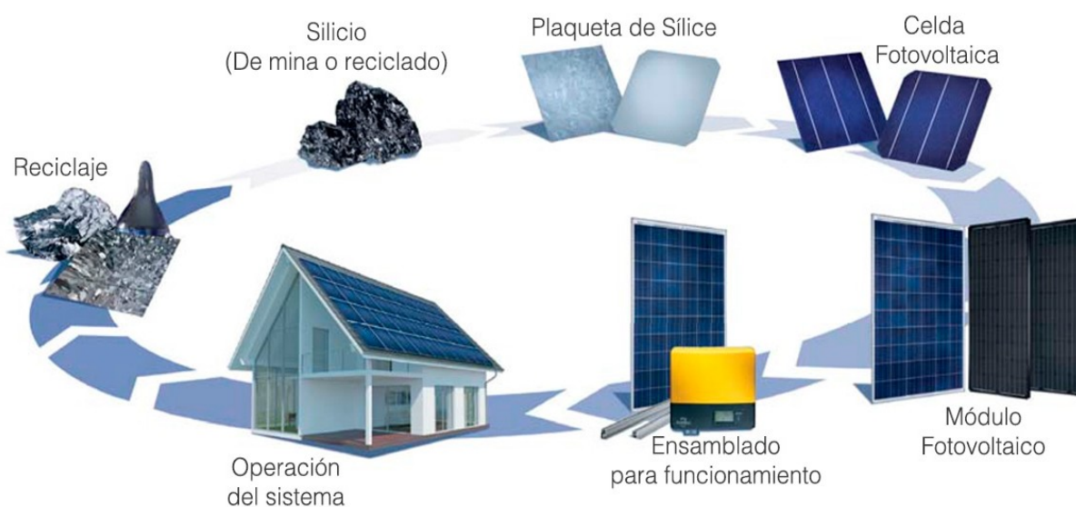
Figuras 2.7: Ciclo de vida de células cristalinas a partir de sílice. Fuente (SolarWorld Inc. 2013).
