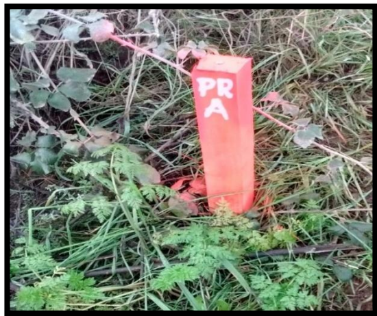
Fotografía C4: Estaca punto de referencia.
