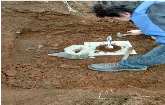
Fotografía B5: Ensayo "Densidad In Situ" C1.
