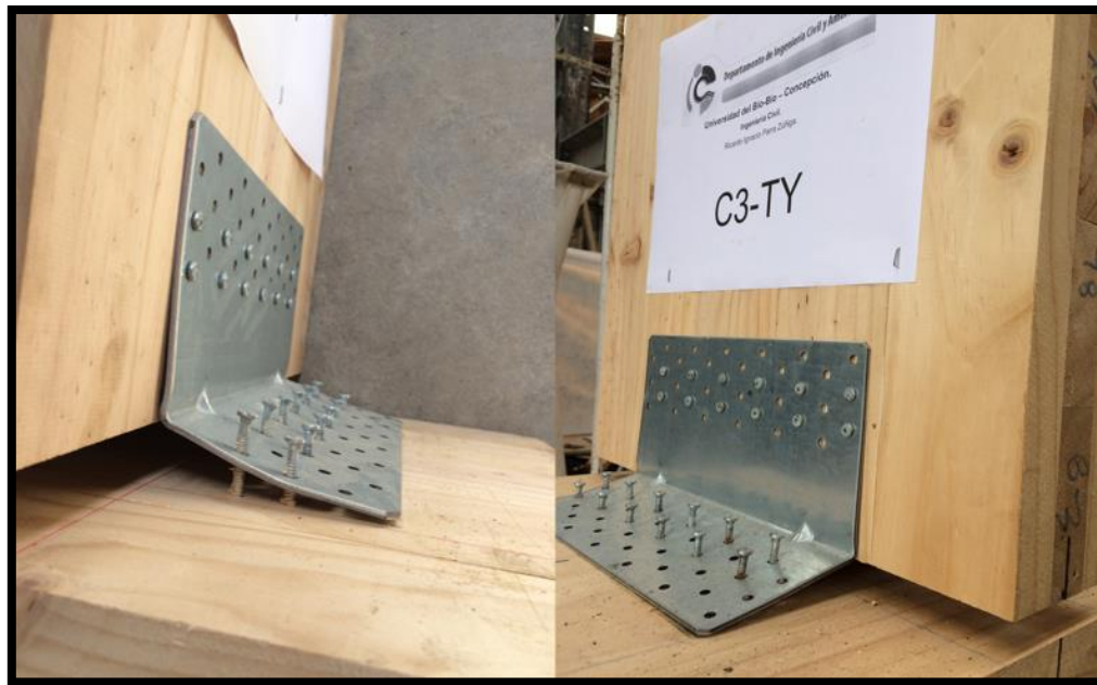
Figura 20. Modo de falla en unión muro-losa conectado con angle bracket cargado en tracción.
