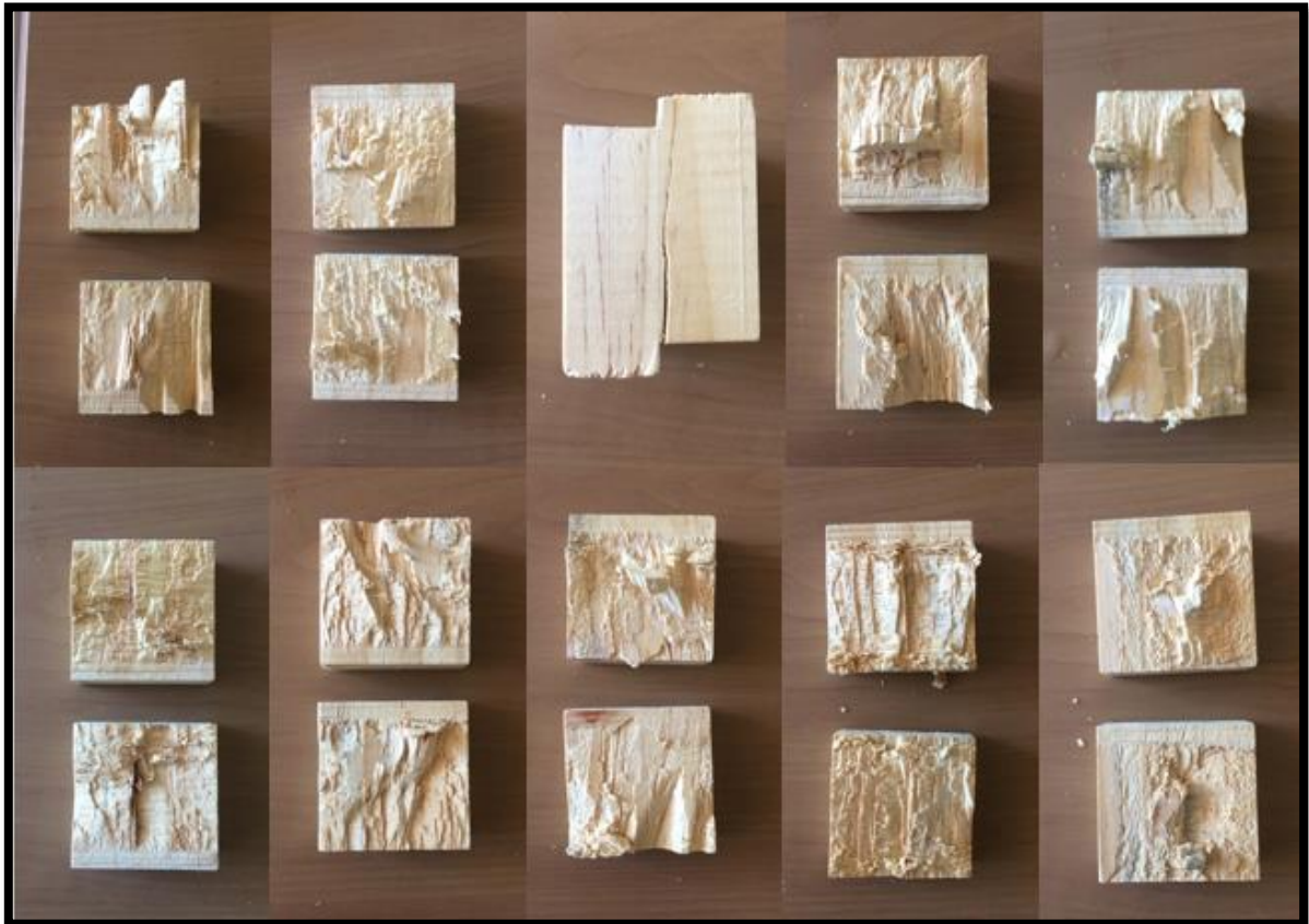
Figura A 4. Falla de la madera en el área cizallada para cada una de las probetas ensayadas.
