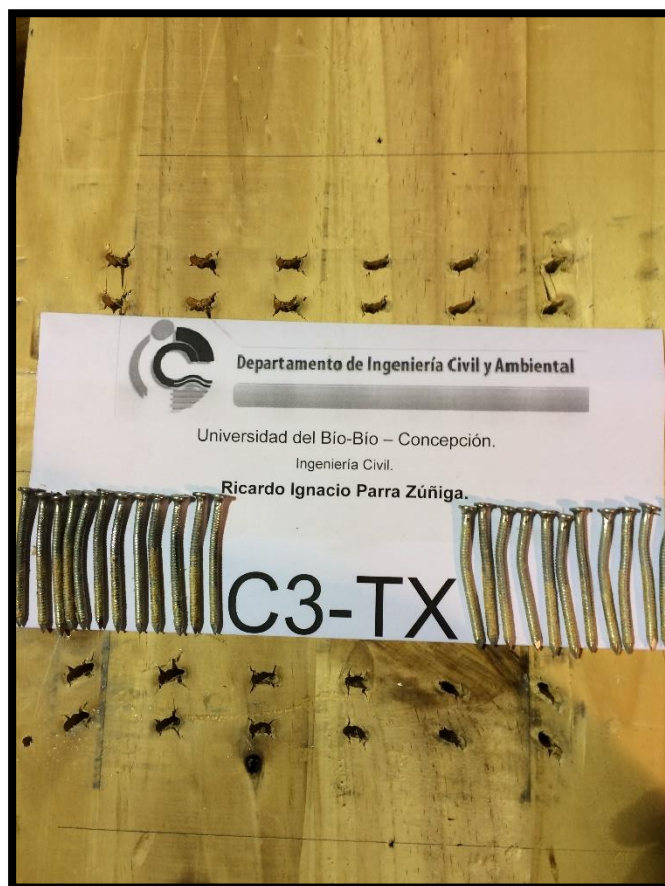
Figura 25. Formación de rotulas plásticas en los clavos y aplastamiento en la madera del panel CLT.
