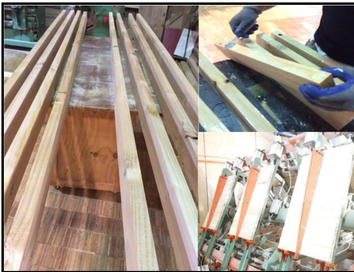
Figura B 1. Calibración de la esquadría, encolado de borde y prensado.
