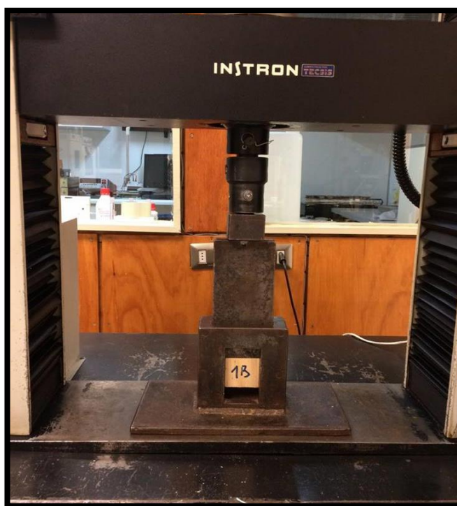
Figura A3. Probeta montada sobre el dispositivo Instron.
