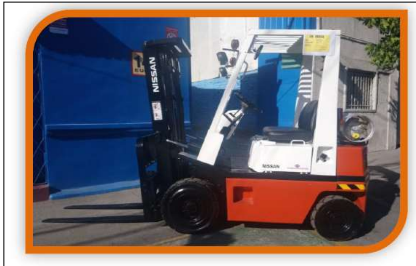
Figura10. Grúa horquilla, Nissan, capacidad de 1,5 toneladas. Fuente: www.guashorquillas.cl
