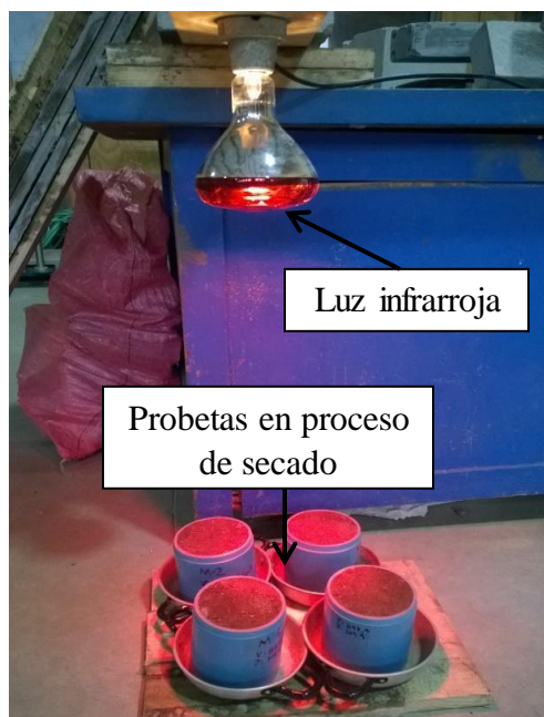
Fig. 8. Proceso de secado de las muestras post-compactación.
