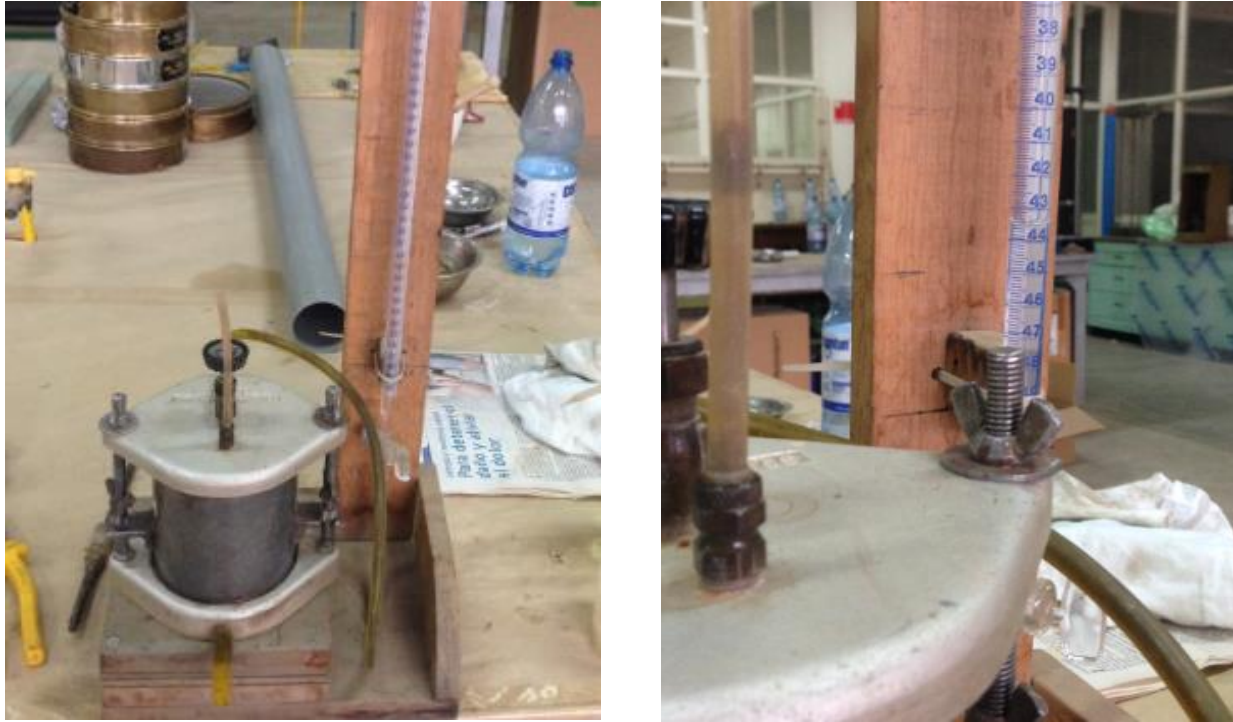
Figura 19: Ensayo con permeámetro de carga variable, laboratorio de la Universidad de Concepción (Fuente: Elaboración propia)
