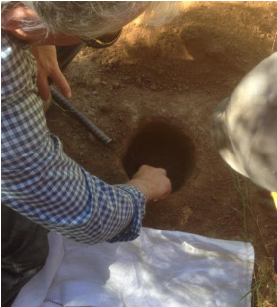
Figura 13: Aplicación método Porchet (Fuente: Elaboración propia)
