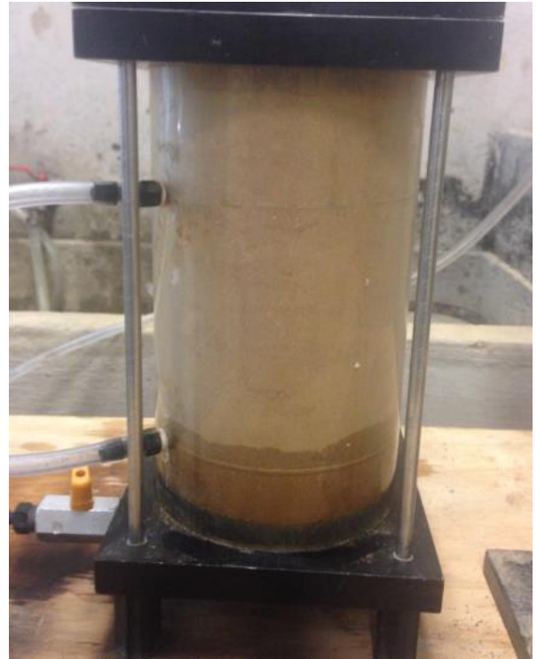
Figura 16: Ensayo con permeámetro de carga variable, laboratorio de la Universidad Católica de la Santísima Concepción (Fuente: Elaboración propia)
