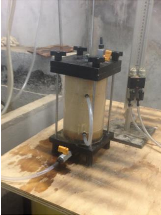
Figura 16: Ensayo con permeámetro de carga variable, laboratorio de la Universidad Católica de la Santísima Concepción (Fuente: Elaboración propia)
