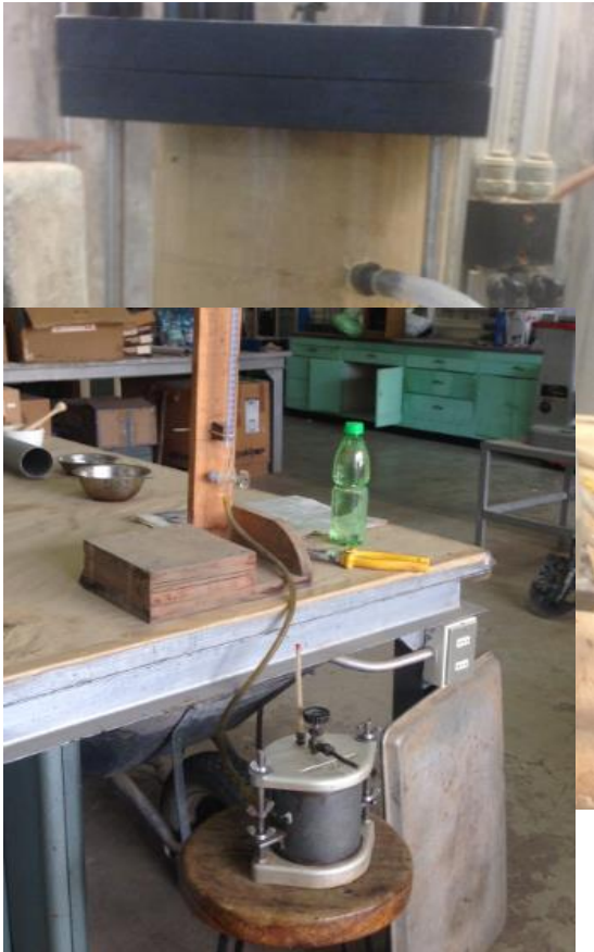
Figura 18: Ensayo con permeámetro de carga variable, laboratorio de la Universidad de Concepción (Fuente: Elaboración propia)
