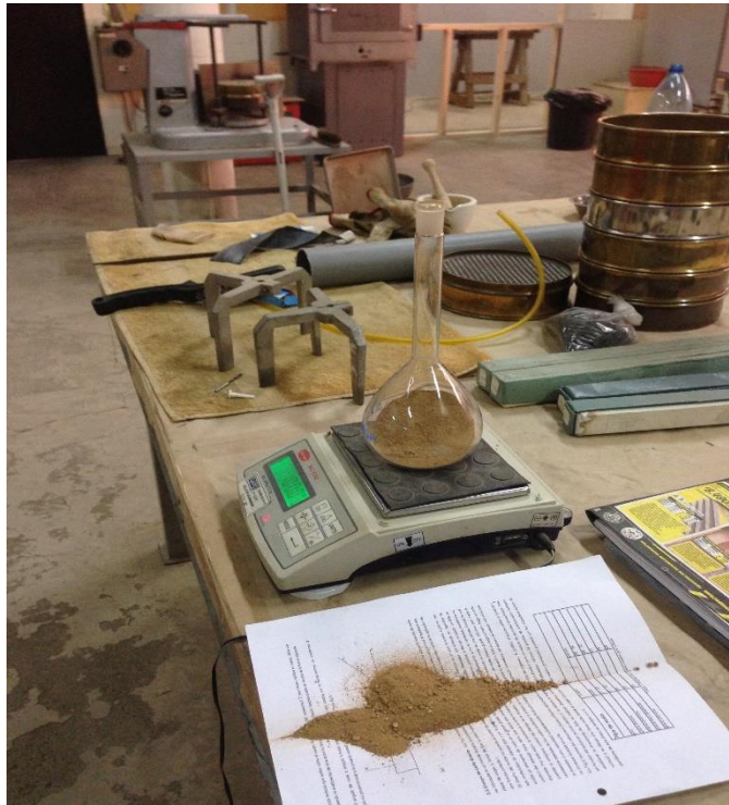
Figura 10: Ensayo picnómetro (Fuente: Elaboración propia)
