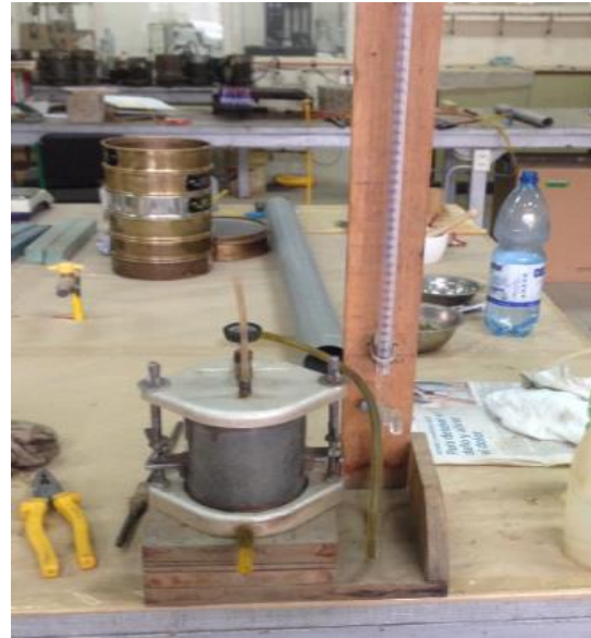
Figura 18: Ensayo con permeámetro de carga variable, laboratorio de la Universidad de Concepción (Fuente: Elaboración propia)
