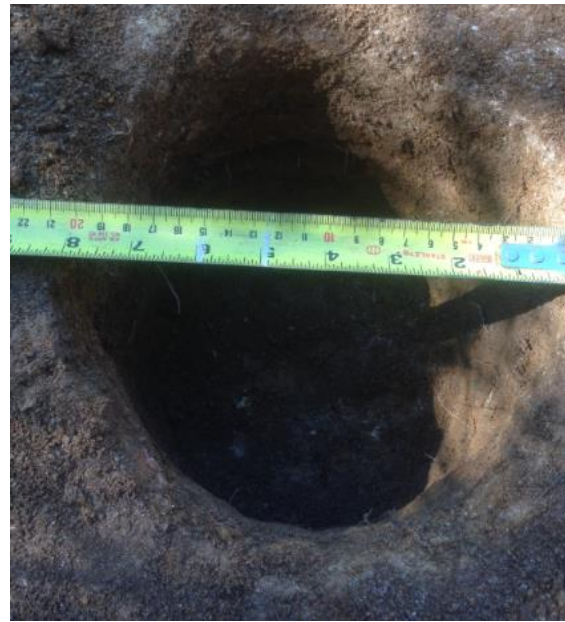
Figura 13: Aplicación método Porchet (Fuente: Elaboración propia)
