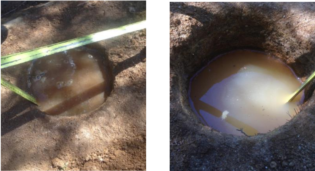
Figura 14: Aplicación método Porchet (Fuente: Elaboración Propia)
