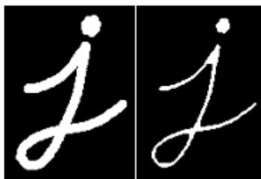
Fig. 4: Efectos de la erosión. A la izquierda se muestra la imagen original, y a la derecha su imagen erosionada Fuente:(OpenCV, n.d.-c).
