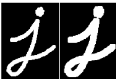
Fig. 5: Efectos de la dilatación. A la izquierda se muestra la imagen original, y a la derecha su imagen dilatada Fuente: (OpenCV, n.d.-c)
