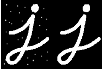
Fig. 6: Efectos de la apertura morfológica. A la izquierda se muestra la imagen original, y a la derecha la misma imagen tras una apertura morfológica. Fuente:(OpenCV, n.d.-c).
