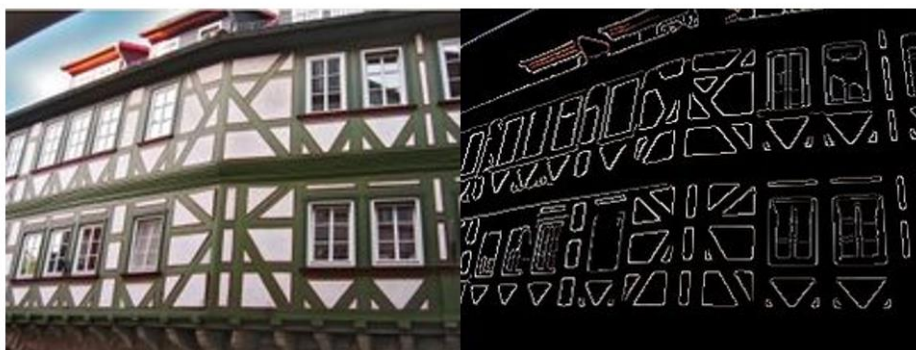
Fig. 11: Detector de bordes de Canny aplicado a una imagen. A la izquierda se muestra la imagen original, y a la derecha los bordes detectados. Fuente: (OpenCV, n.d.-b)
