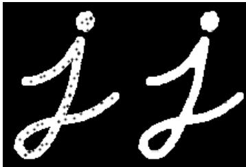
Fig. 7: Efectos del cerrado morfológico. A la izquierda se muestra la imagen original, y a la derecha la misma imagen tras un cerrado morfológico. Fuente:(OpenCV, n.d.-c).
