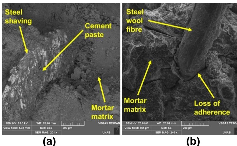
Figura 12. Imágenes SEM de la superficie de fractura en muestras con (a) virutas y (b) fibras metálicas.
