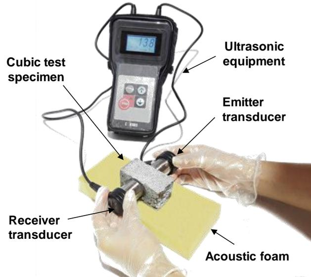
Figura 3. Medida del módulo de elasticidad dinámico de los morteros mediante ensayo por ultrasonido.
