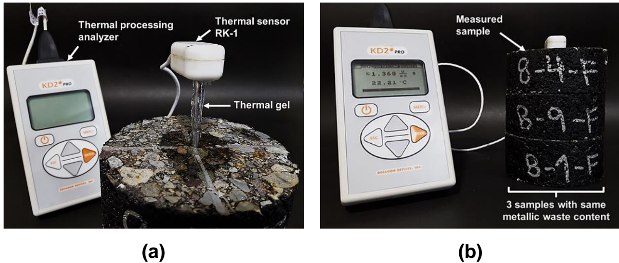
Fig. 3. (a) Controlador manual y sensor térmico, y (b) medición de la conductividad térmica.
