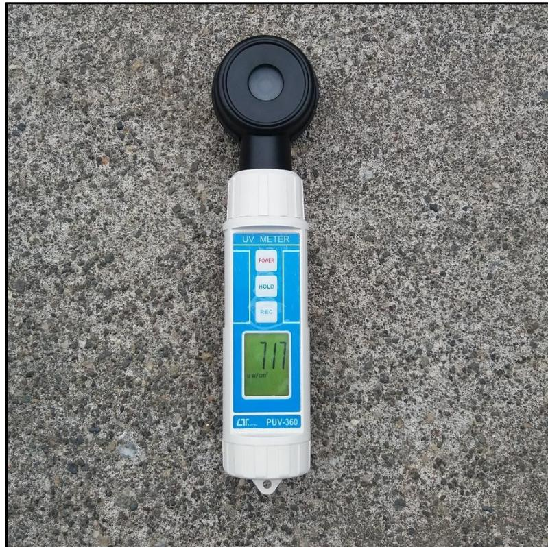
**Figura C4: Medidor de radiación ultravioleta**
