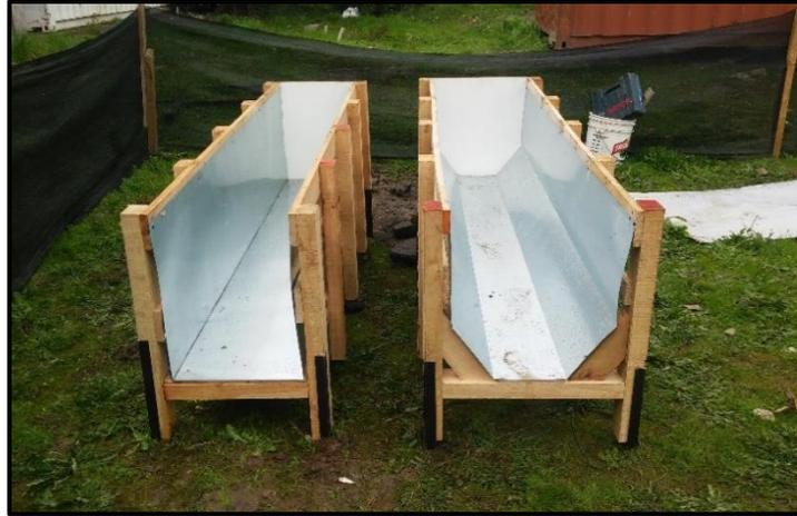
**Figura A4: Canales con superficie reflectante.**
