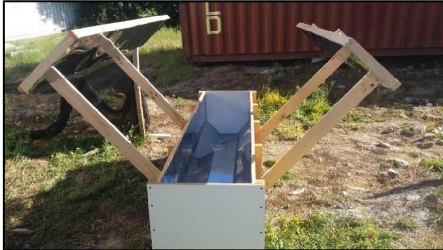
**Figura C3: Instalación de paneles reflectantes**
