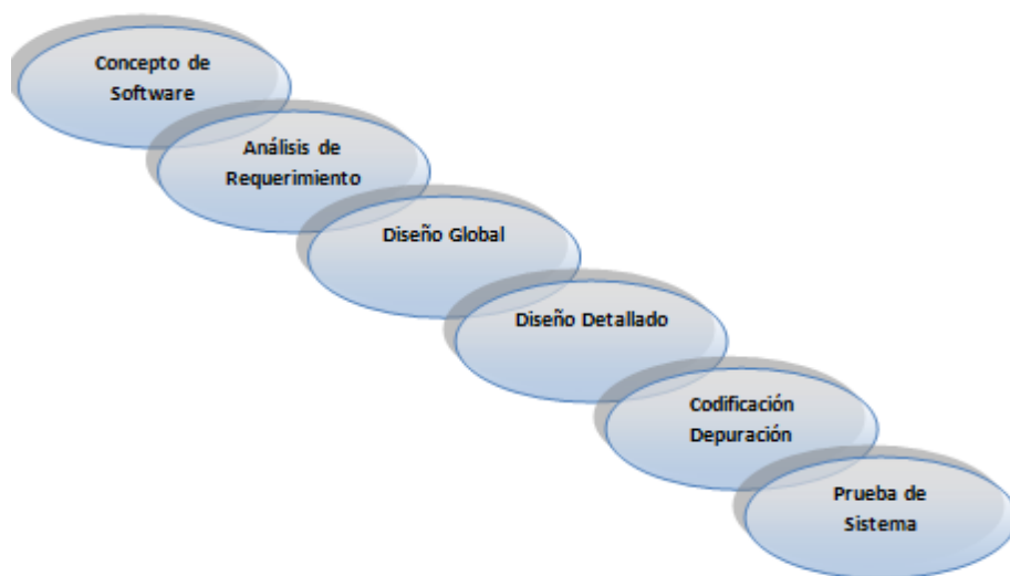
FIGURA N° 93: Cascada con Fases Solapadas Fuente: Elaboración propia a partir de Royce (1995)
