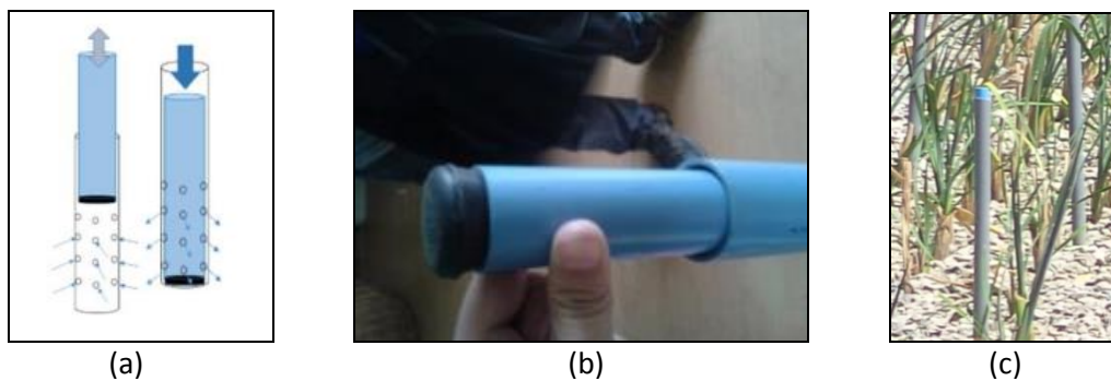
Figura N°10. (a) Diseño del flujo de agua del dispositivo de medición (Fuente: Dappollonio, 2015). (b) Tubos de PVC interno y externo (Fuente: Dappollonio, 2015). (c) Dispositivo inserto en humedal Bulnes (Fuente: propia).
