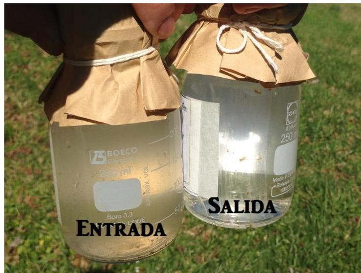
*Figura 19. Muestras del Afluente y Efluente en el humedal de Bulnes.*
