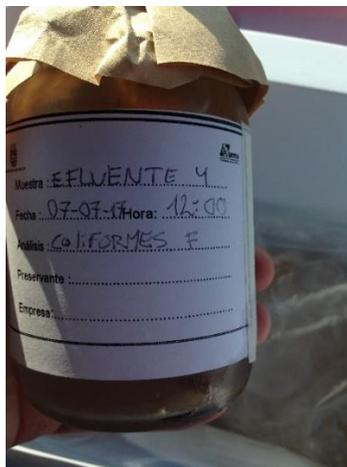
*Figura 21. Frasco facilitado por el laboratorio para la toma de muestras.*
