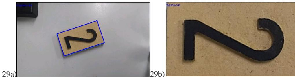
Figura 29. Transformación de corrección de perspectiva de la región de interés.
