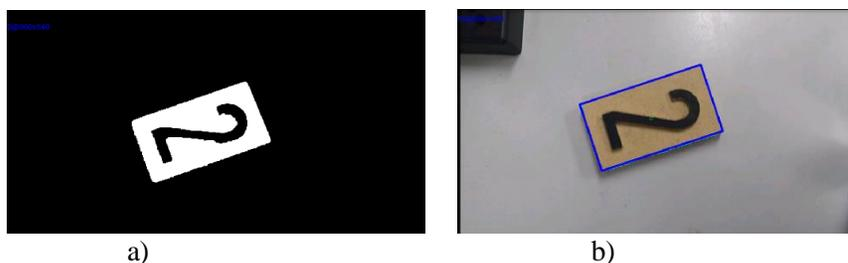
Figura 28. Definición de la región de interés del objeto mediante un color específico.
