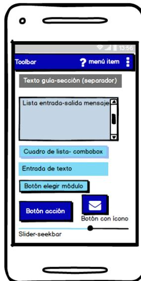
Figura 49. Diseño de componentes de la interfaz gráfica (GUI) de la aplicación.
