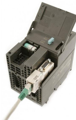
Ilustración 10. Conexión S7-300 con Netlink PRO Compact
