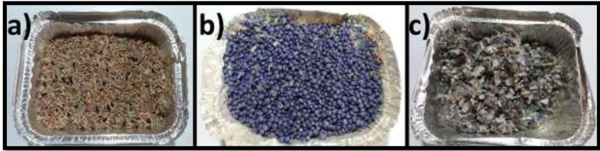
Componentes de la hidrosiembra. a) Semillas, b) Fertilizante, c) Mulch. (Fuente: Elaboración propia)
