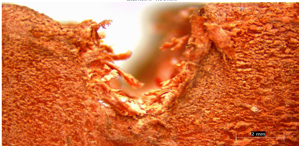
Figura C.5 "Aplastamiento en probeta de Raulí en carga paralela a la fibra y con tornillo autoperforante de diámetro 3.6 mm
