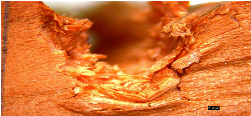
Figura C.6 “Aplastamiento en probeta de Raulí en carga perpendicular a la fibra y con tornillo autoperforante de diámetro 3.6 mm”
