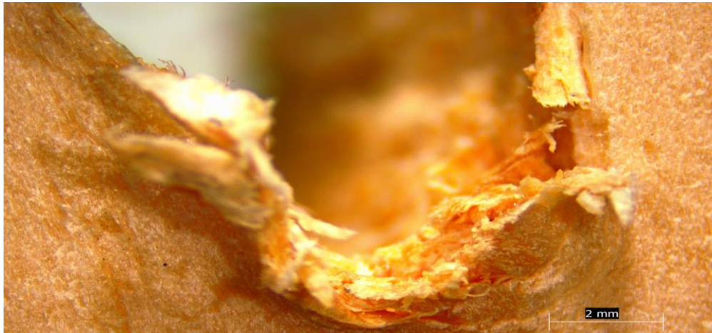
Figura C.3 "Aplastamiento en probeta de Pino Radiata en carga paralela a la fibra y con tornillo autoperforante de diámetro 4.1mm
