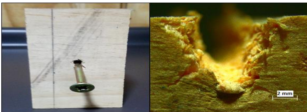
Figura 4.3. Fallo típico de probeta producto del ensayo de resistencia al aplastamiento.
