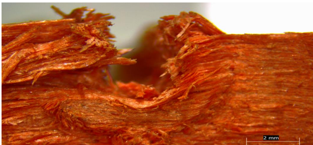
Figura C.10 "Aplastamiento en probeta de Rauli en carga perpendicular a la fibra y con tornillo autoperforante de diámetro 2.8 mm"
