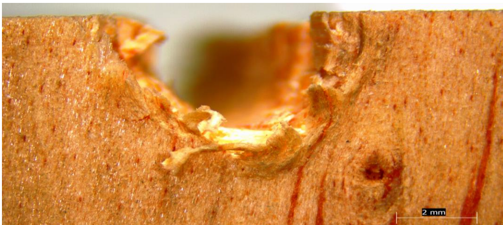
Figura C.7 “Aplastamiento en probeta de Pino Radiata en carga paralela a la fibra y con tornillo autoperforante de diámetro 3.6 mm”
