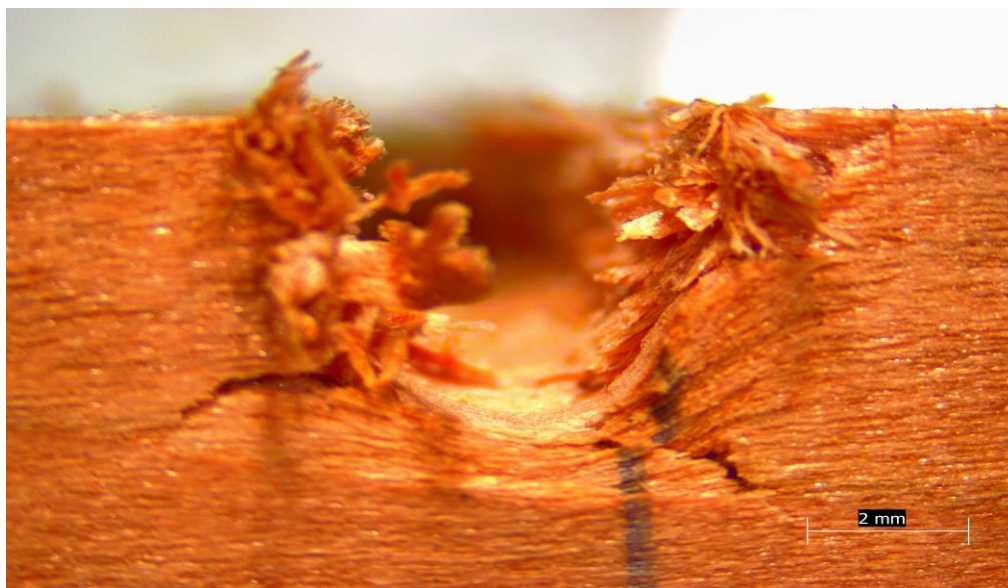
Figura C.2 "Aplastamiento en probeta de raulí en carga perpendicular a la fibra y con tornillo autoperforante de diámetro 4.11mm
