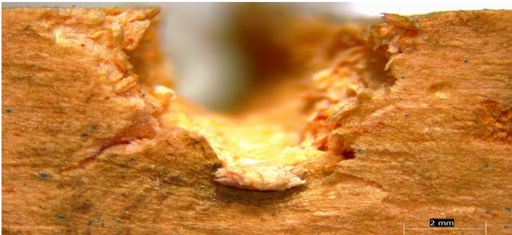
Figura C.8 “Aplastamiento en probeta de Pino Radiata en carga perpendicular a la fibra y con tornillo autoperforante de diámetro 3.6 mm”
