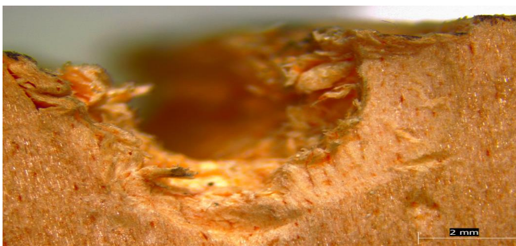
Figura C.11 "Aplastamiento en probeta de Pino Radiata en carga paralela a la fibra y con tornillo autoperforante de diámetro 2.8 mm"
