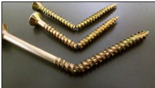
Figura 4.1. Fallo a flexión en tornillos autoperforantes
